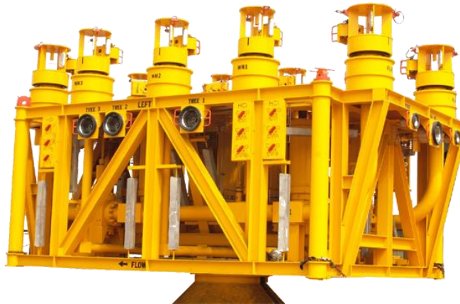
Fig.2.7 Manifold Arreglo Clúster (Schlumberger-Cameron) 28
