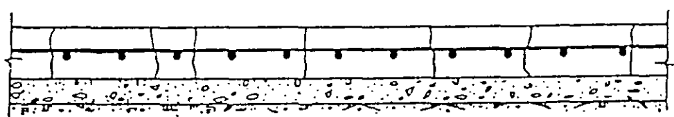
PAVIMENTO DE CONCRETO CON REFUERZO CONTINUO
