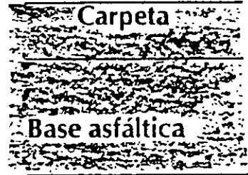
b) Asfáltico pleno (Full depth)
