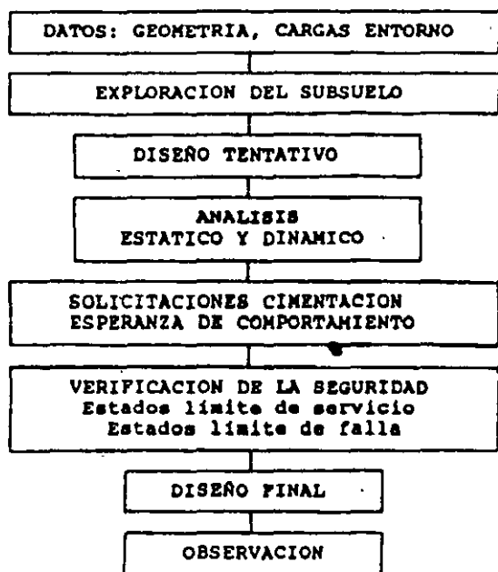
Fig 7. Proceso de diseño de una cimentación
