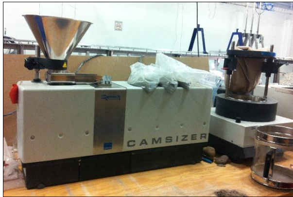
Fig. 3.11 Camsizer para generar curva granulométrica de la arena utilizada en los ensayos.
