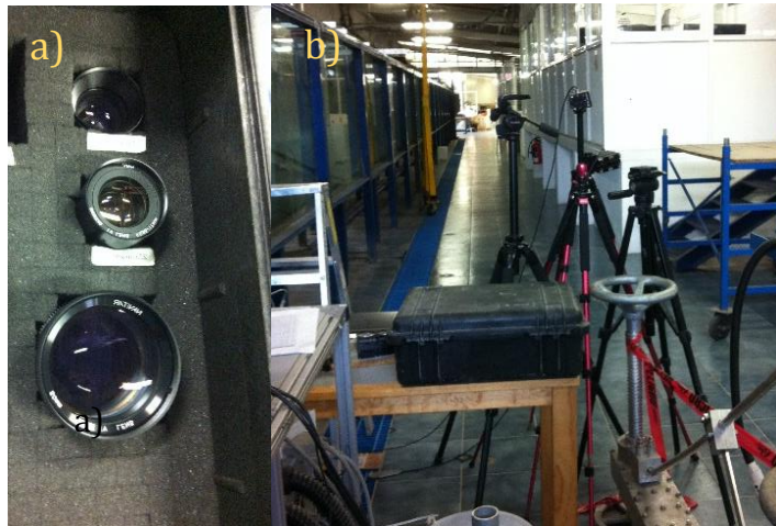
Fig. 3.10 a) Cámara de alta velocidad, b) Localización de la cámara enfocando la parte de la berma y las dunas.
