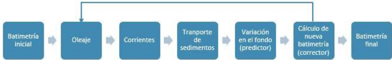
Fig. 4.1 Esquema que sigue el modelo numérico para el cálculo de la evolución del perfil de playa.
