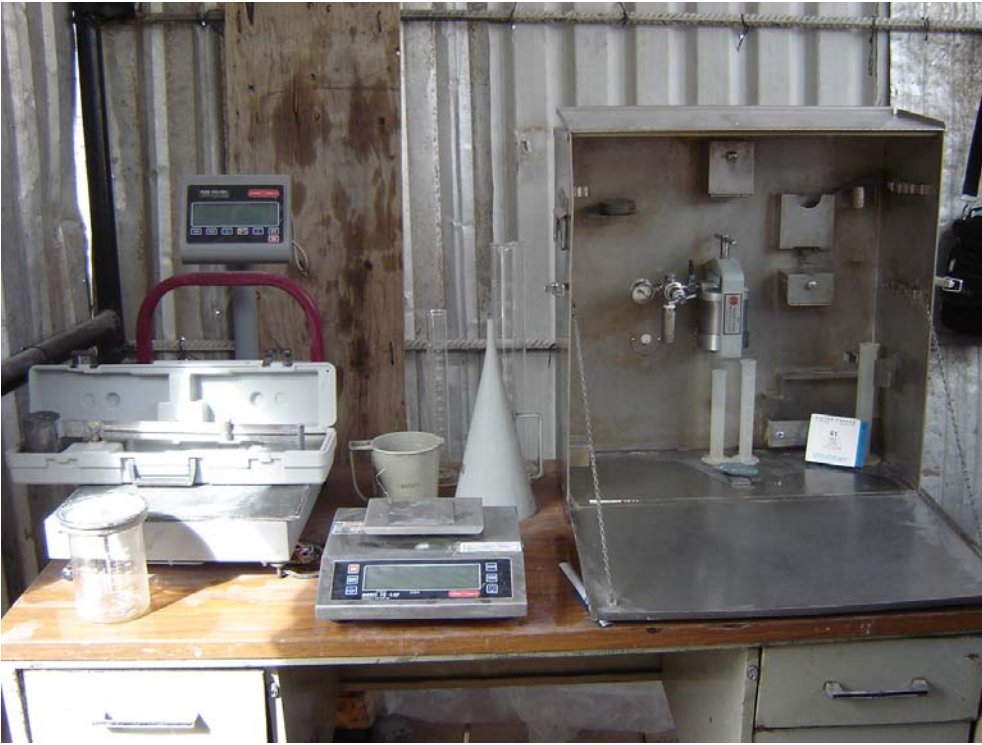
Foto 8. Equipo para pruebas de lechada de inyección
