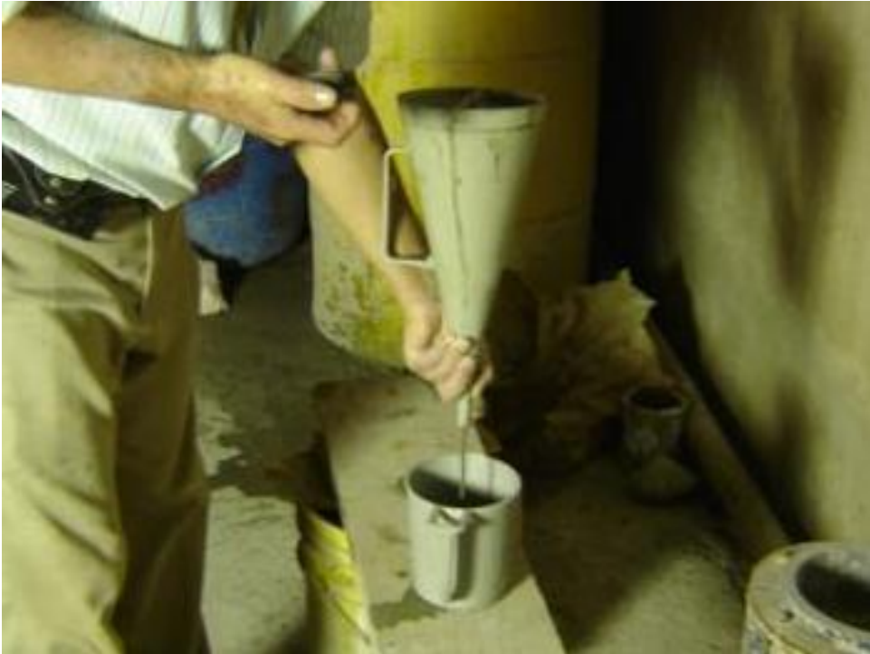
Foto 9. Prueba de Viscosidad
