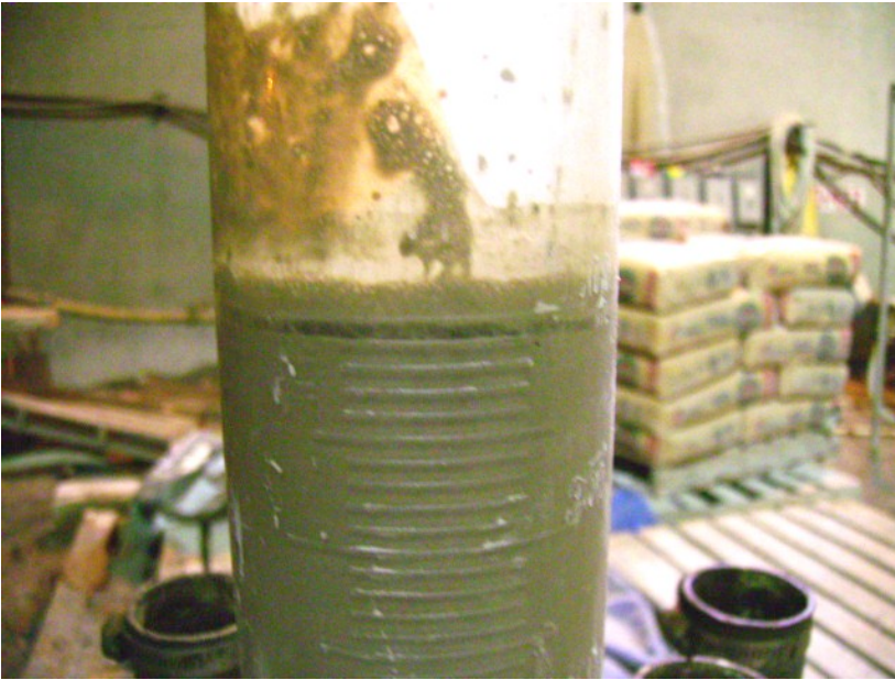
Foto 10. Prueba de Decantación
