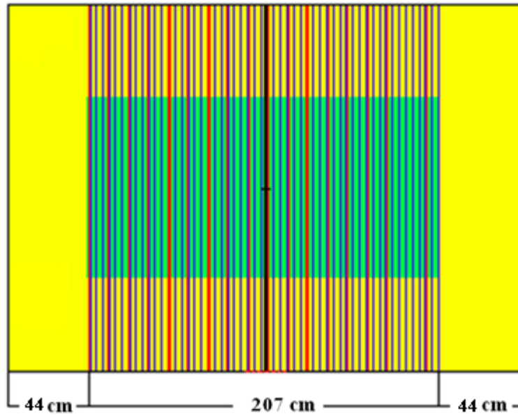
Figura 5.10 Vista lateral del núcleo; PY=0; MCNPX
