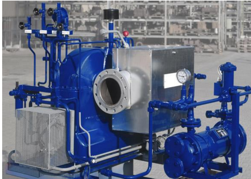
Figura 14. Turbina de vapor siemens SST -050 de 750 KWH
