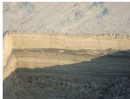
Lámina VI.2. Trincheras en Playa la Trocha, en donde se observan laminaciones de minerales oscuros.
