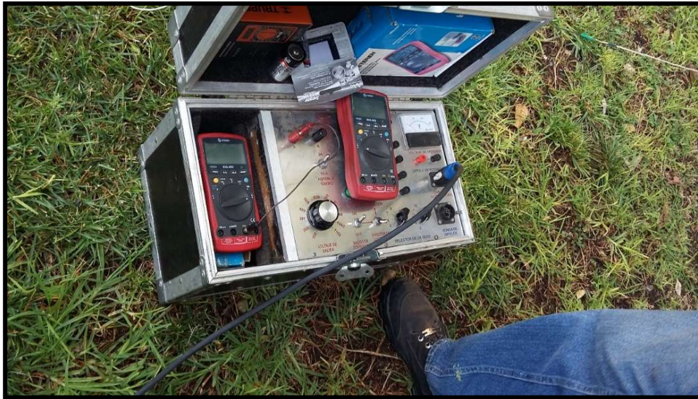
Figura 30 Equipo geofísico utilizado para la toma de datos en la hacienda de Santa Rosa Xajay
