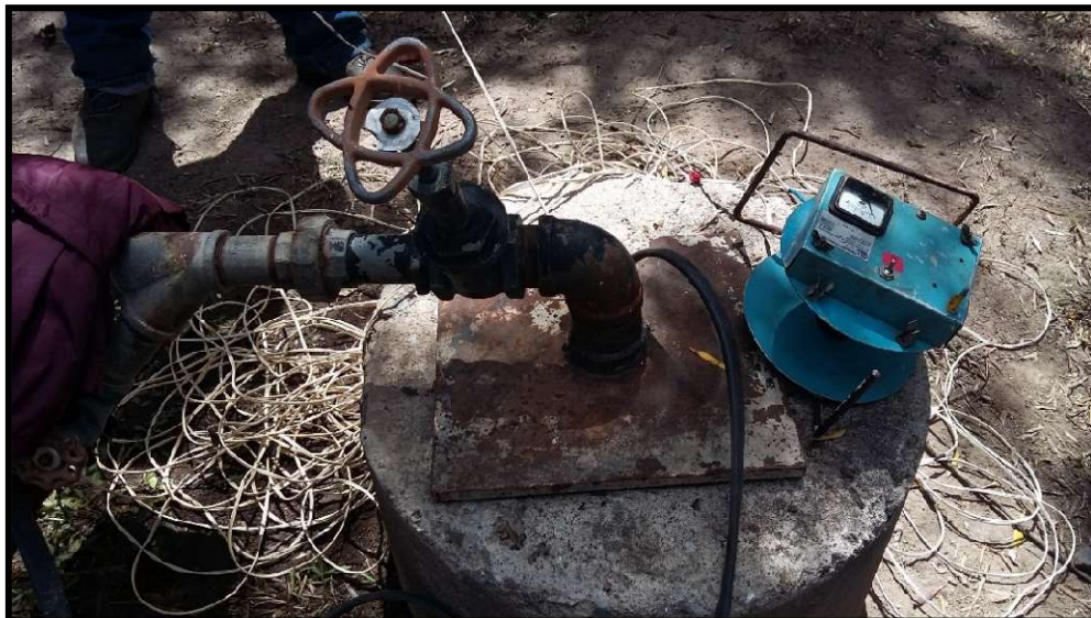
Figura 29 Pozo activo de la hacienda de Santa Rosa Xajay, midiendo la profundidad en donde se encuentra el nivel freático.
