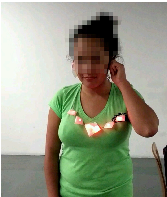
Fig. 55. En el Taller de Wearables, l@s participantes desarrollaron proyectos como éste, de joyería lumínica reactiva al ritmo cardiaco de la persona usuaria. Realizado con IDE Arduino, sensor comercial de ritmo cardiaco y LEDs RGB.
