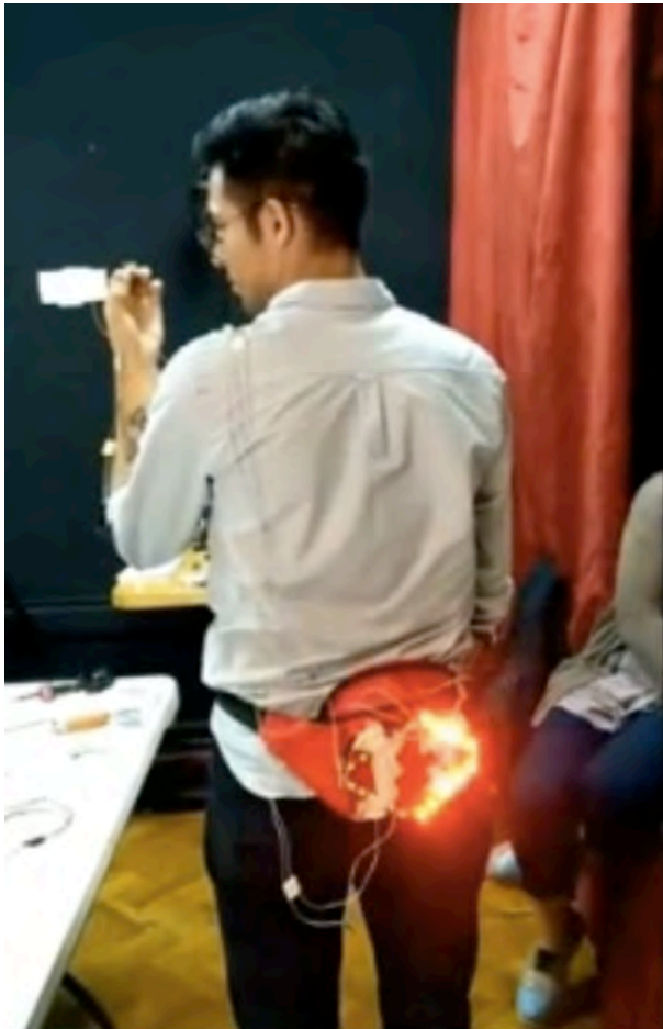
Fig. 65. Un participante probando el funcionamiento de luces direccionales, las cuales agregó en una prenda tipo bandolera o "cangurera". El control de las direccionales fue establecido con movimiento de los dedos de la mano, el cual implementó en un guante.
