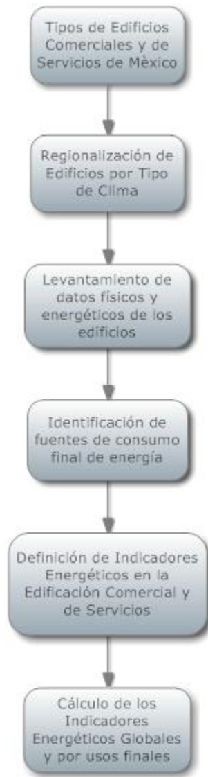
Ilustración 4 Diagrama de Flujo de la Metodología empleada para cálculo de indicadores energéticos en Edificios Comerciales y de servicios de la República Mexicana
