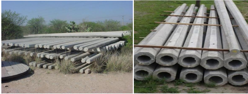
Figura 1.31 Postes de concreto con acero de refuerzo en almacén a cielo abierto.
