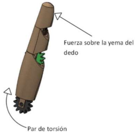
Figura A.8: Esquema de la fuerza del dedo y el par de torsión (Garibay, 2013).
