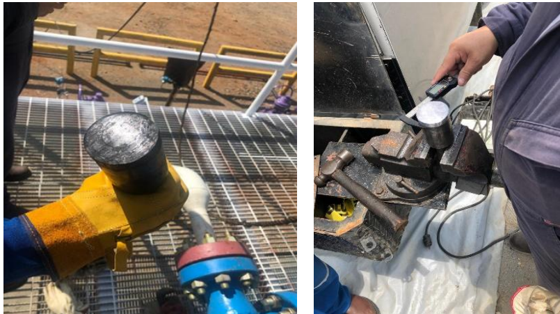
Figura 4.17 Sello de plomo de 2.250" utilizado para calibración de TP de 2 7/8" del pozo "A"
