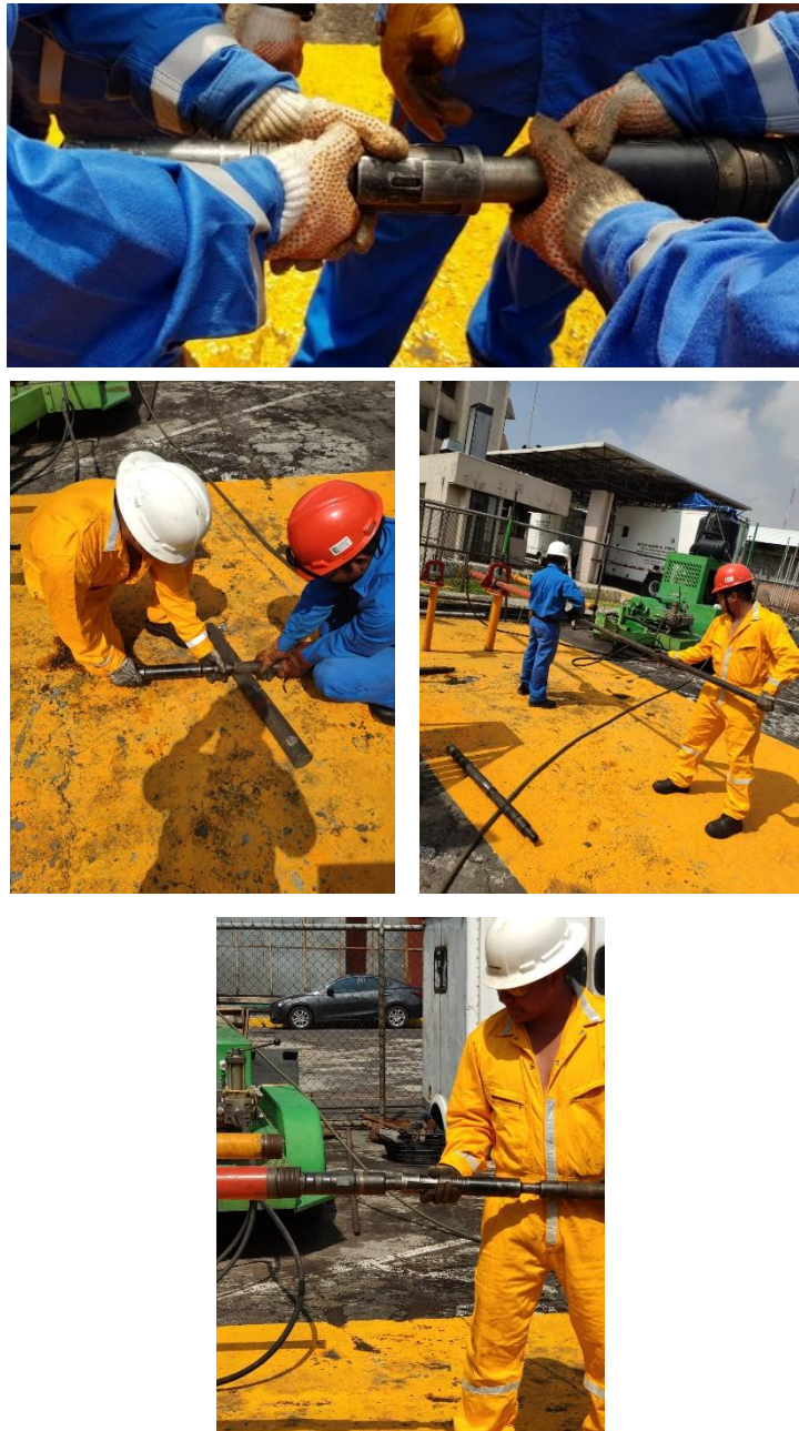
Figura 4.16 Pruebas de anclaje y desanclaje del MPFV®
