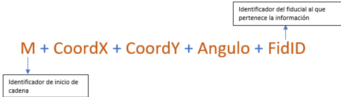
Figura 44. Estructura de la cadena de datos para la transmisión de la información.
