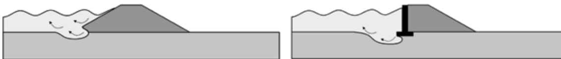
Figura 2.13 Erosión externa del pie y cimentación de un bordo (Sharp et al. , 2013)
