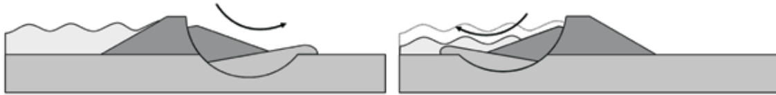
Figura 2.23 Deslizamiento de rotación poco profundo que afecta a una pared en la cresta de bordos (Sharp et al. , 2013)
