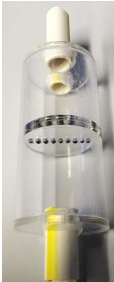
Ilustración 63 Perpendicularidad entre micro canales y alimentadores.
