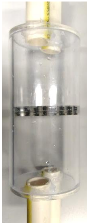
Ilustración 66 Vista lateral ensamble por adhesión.
