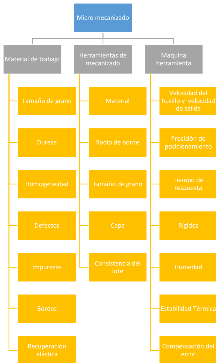
Ilustración 18 Esquema de aspectos clave en micro fresado [39]
