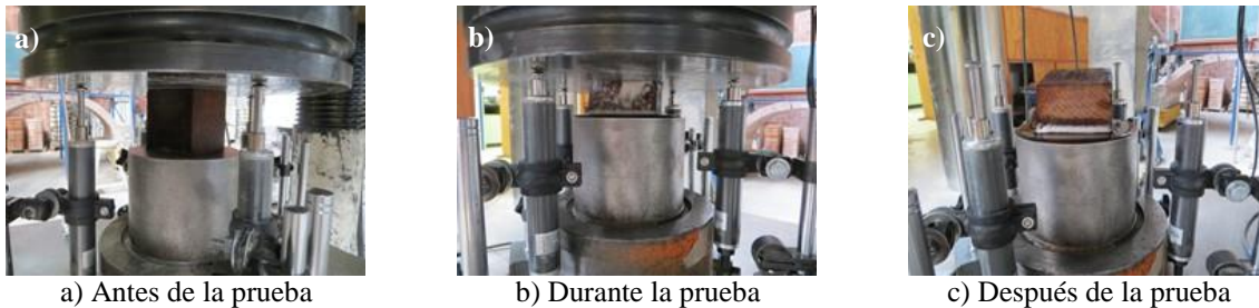
Figura 4.13 Proceso de deformación en un cubo que estuvo en el cuarto húmedo.
