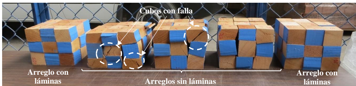
Figura 4.24 Comparación de deformación de arreglos de 3×3 cubos con y sin lámina.
