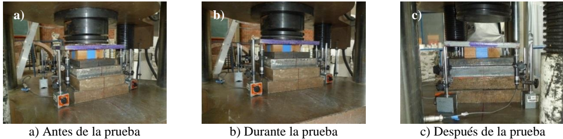
Figura 4.19 Proceso de deformación en un arreglo de 3×3 cubos de un nivel.
