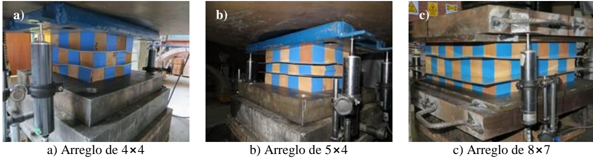
Figura 4.26 Deformación en arreglos de tres niveles de cubos de madera de caobilla.
