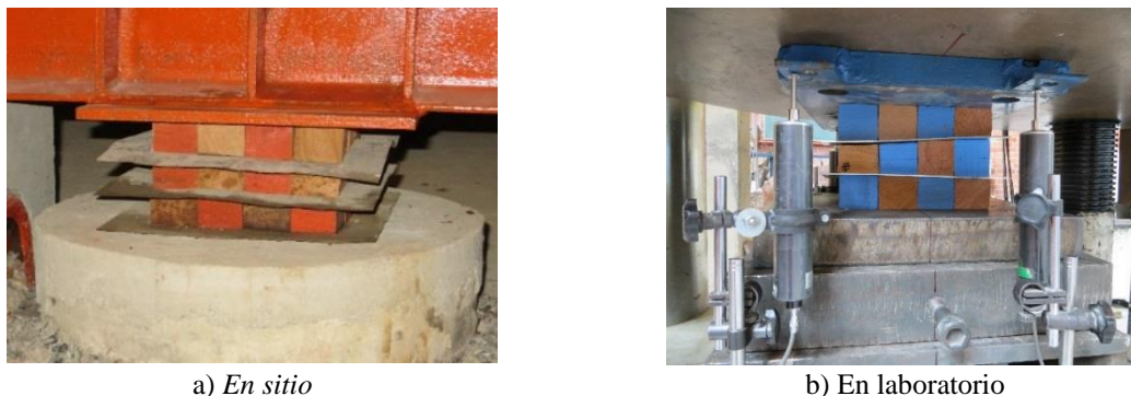
Figura 2.27 Celda de deformación con cubos húmedos y láminas deformadas.
