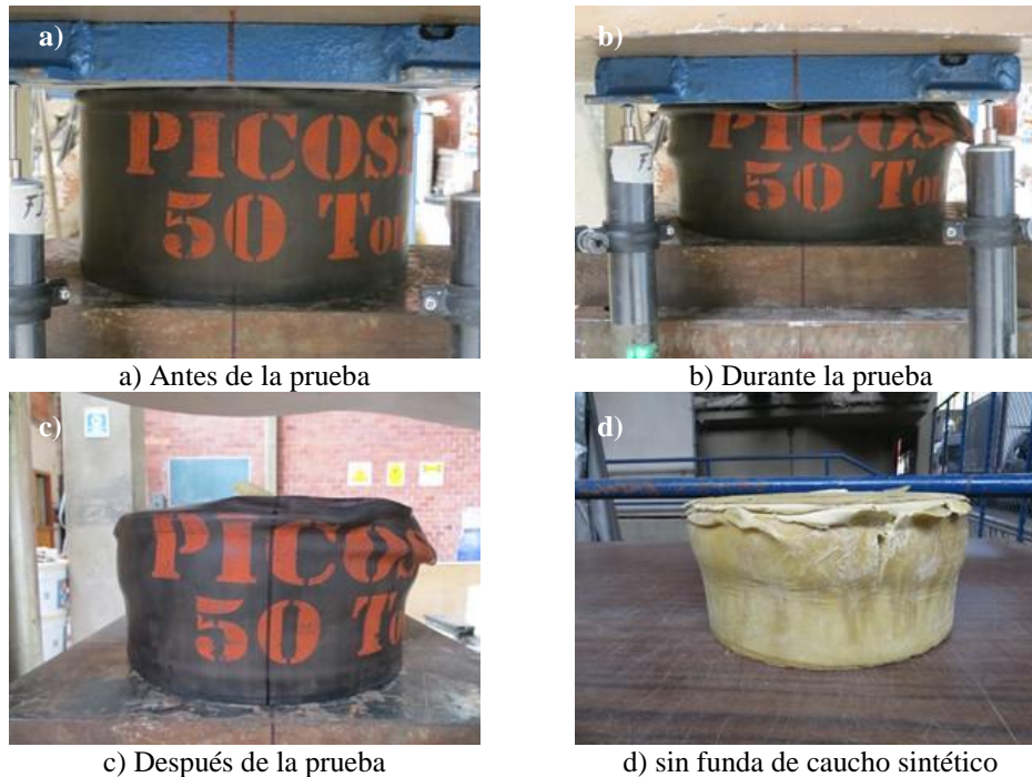
Figura 4.33 Proceso de deformación de los cilindros poliméricos con capacidad de 490 kN (50 t).
