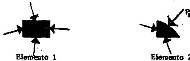
Fig. 3.8. Diagramas de cuerpo libre de los elementos 1 y 2.
