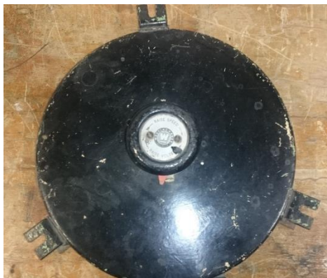
Figura B.3. Transformador Variable (VARIAC).
