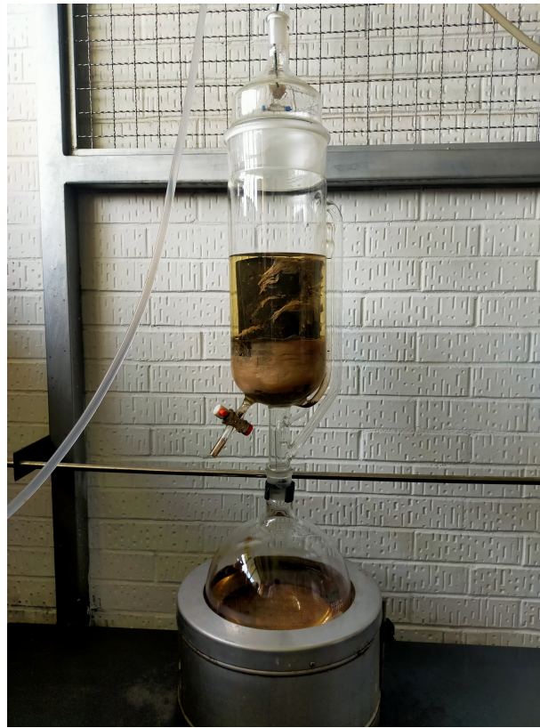
Figura 3.7: Equipo Dean Stark usado para lavado de muestras.
