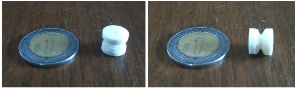
Figura 4.16 Polea cable comparada con una moneda de 1 MXN cuyo diámetro es de 21 mm (elaboración propia).
