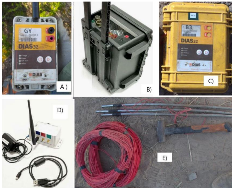
Figura 4.9. Equipo de adquisición DIAS32. A) Receptores (nodos) B) Transmisor 25 kW C) Registrador de corriente D) Transceptor E) Cable de cobre, electrodos de acero inoxidable y marro.
