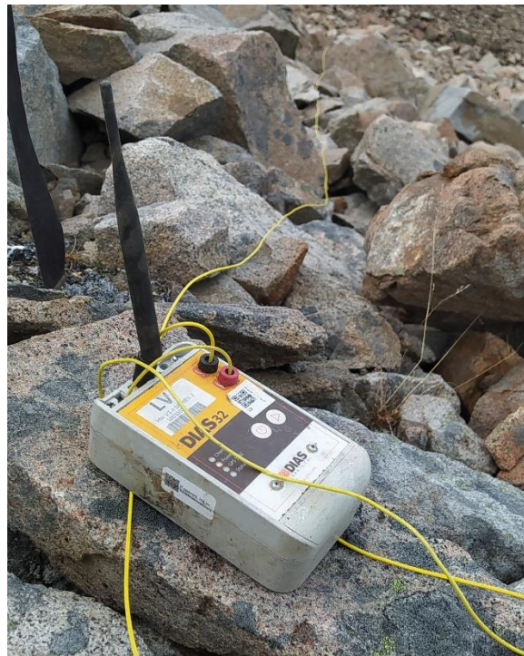
Fig. 3.2. Cableado y receptor en una línea
