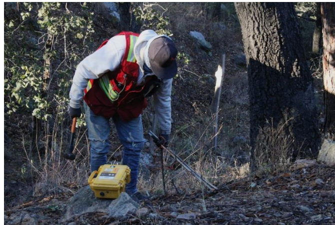
Fig. 3.3. Instalación de electrodos y equipos de registro de corriente
