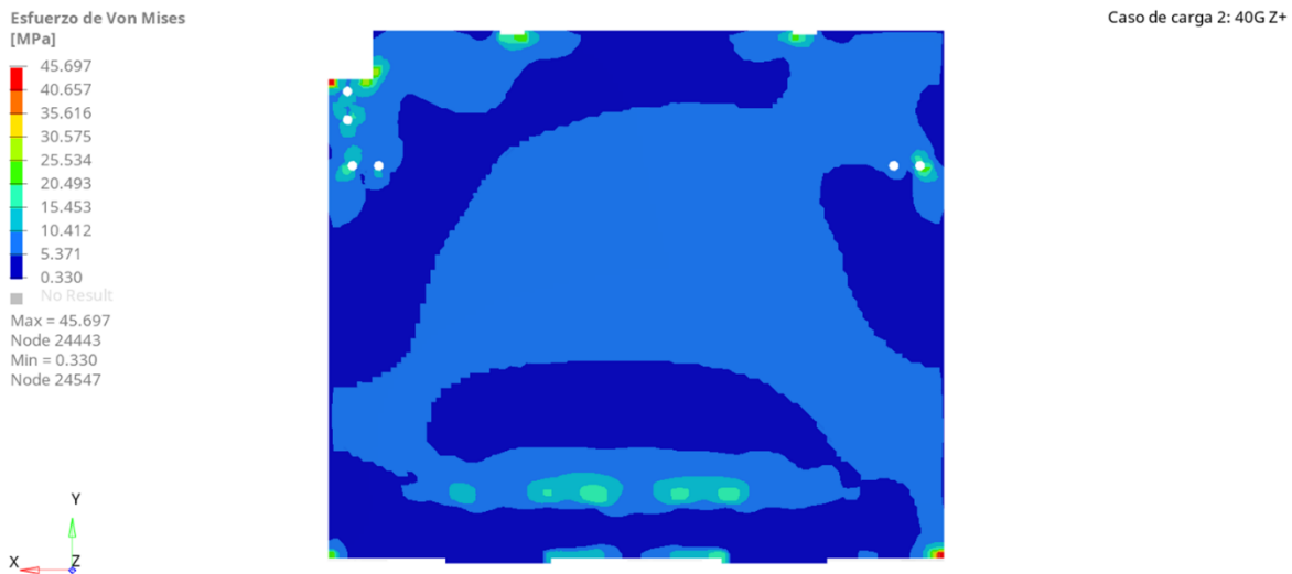
Figura 4.37 Resultado esfuerzo de von Mises pared exterior del acumulador 40 G Z+
