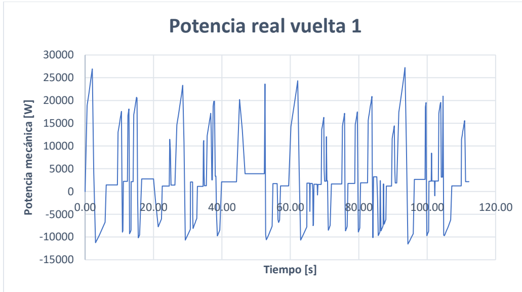
Gráfica 3.4. Potencia real considerando pérdidas para la vuelta 1 de la prueba de resistencia
