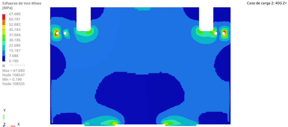
Figura 4.36 Resultado esfuerzo de von Mises pared interior del acumulador 40 G Z+
