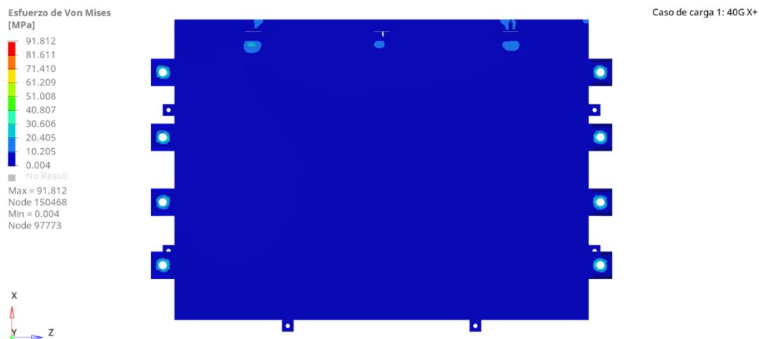
Figura 7.23 Contenedor del arreglo esfuerzo de von Mises caso de carga 1 vista de planta
