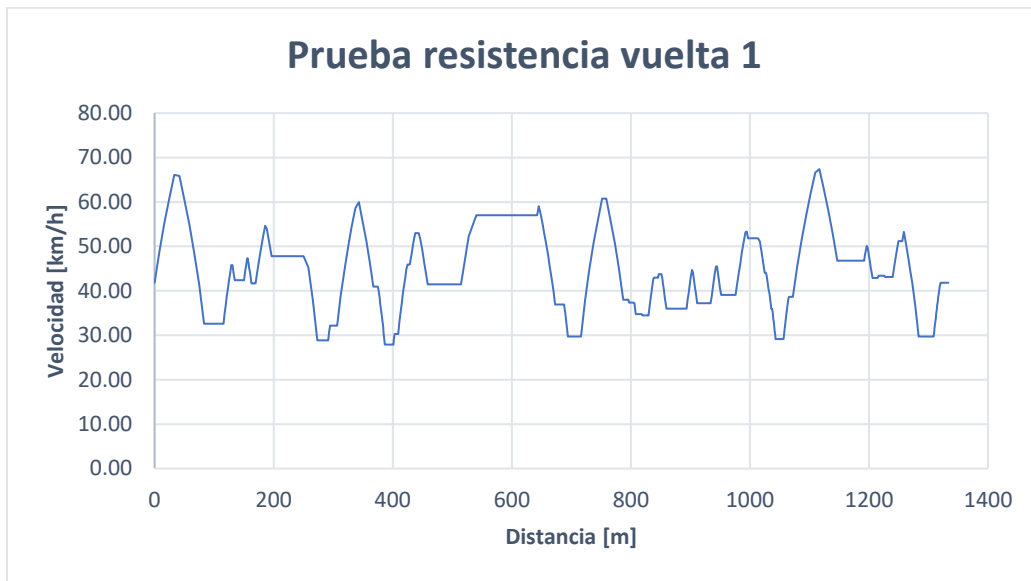
Gráfica 3.2. Velocidad del vehículo a lo largo de la pista de resistencia.
