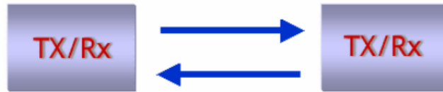
Figura 4.7 Operación en modo transparente (half-dúplex). [23]
