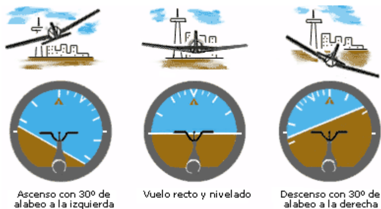
Figura 3. 8 Interpretación grafica del horizonte artificial. [11]
