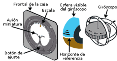
Figura 3. 9 Componentes de un horizonte artificial mecánico. [12]
