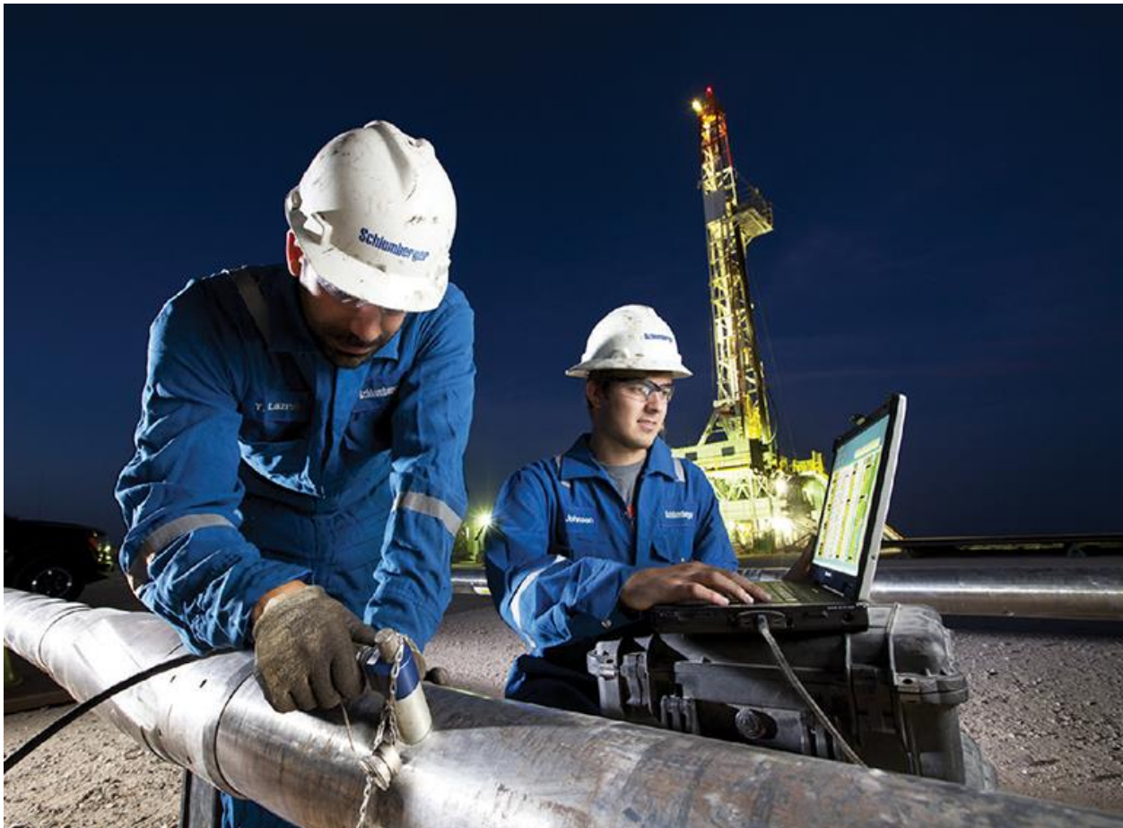
Figura 2.4. Ingenieros de Schlumberger descargando datos desde la herramienta de evaluación de formación NeoScope registrando mientras se perfora (Schlumberger, 2015).
