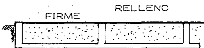
LOSA CON TRABES HACIA ARRIBA
