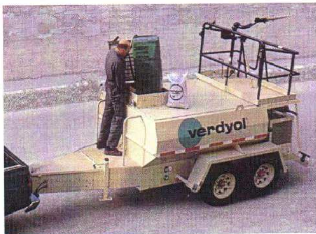
Ejemplo de hidrosiembra con bomba hidráulica
