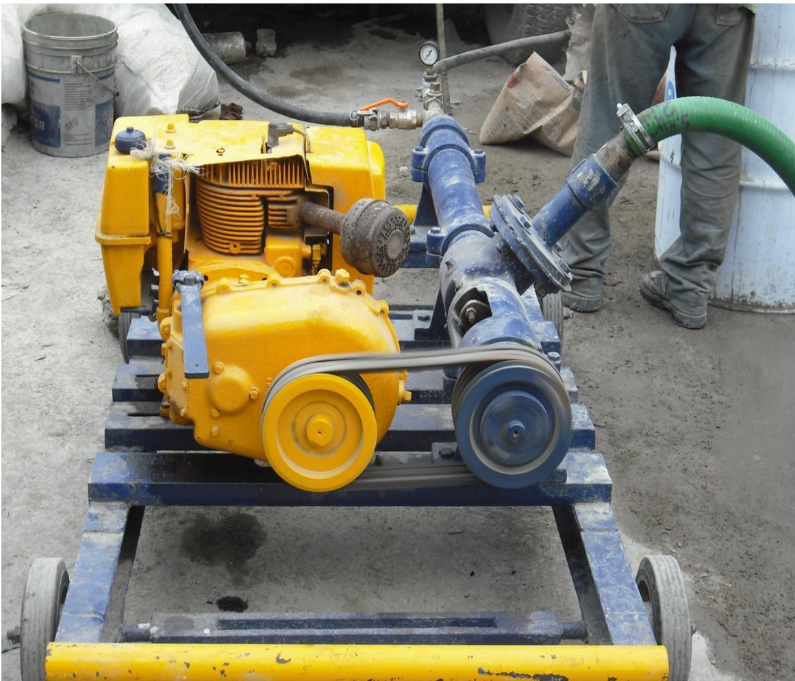
Figura 85. Bomba Moyno con manómetro para inyección de lechada agua-cemento.
