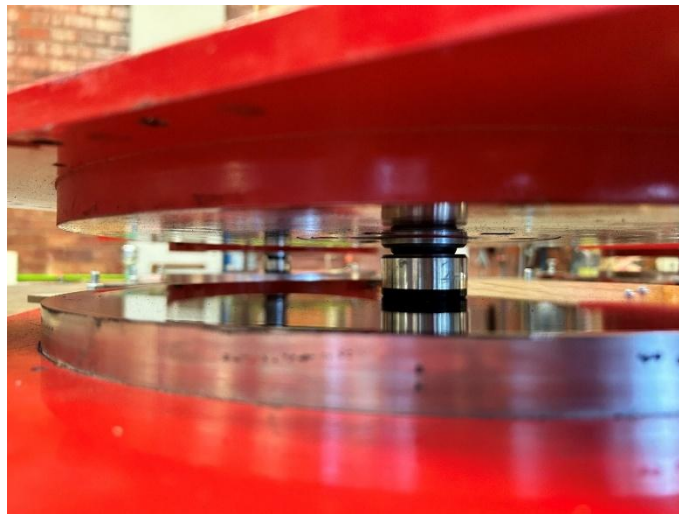
Figura 11. Articulación colocada entre placas de aislador sísmico.
