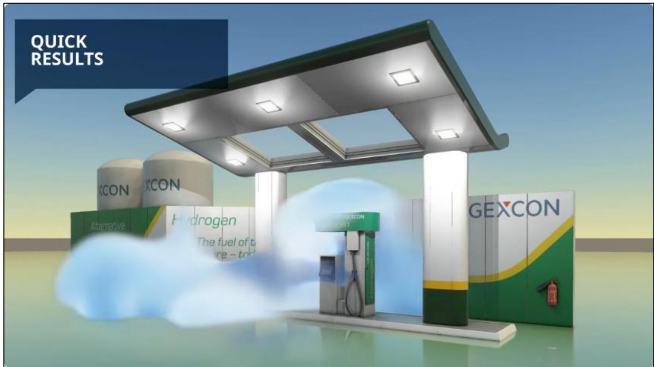
Figura 3.48. Simulación 3D de una fuga de gas de FLACS™. Fuente: Gexcon, 2022.
