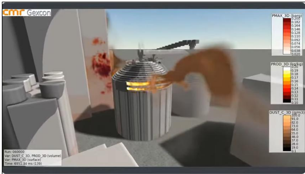
Figura 3.52. Simulación de una explosión de polvo de FLACS™. Fuente: Gexcon, 2017.
