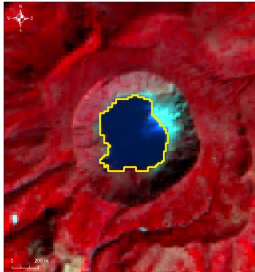
Figura 51. Composición RGB543 y el contorno en color amarillo de la superficie del lago obtenido por clasificación supervisada.
