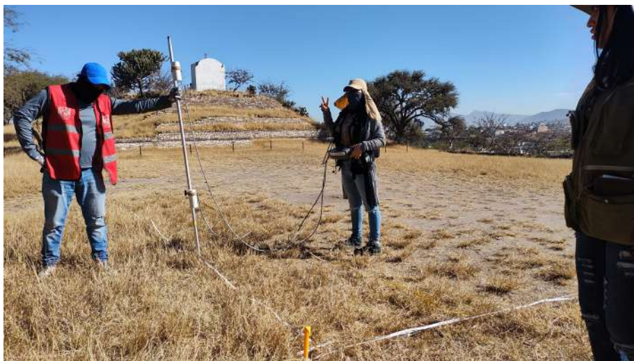
Figura 72: Adquisición de datos de Magnetometría. Fotografía tomada por alumnos de Prácticas profesionales (semestre 2023-I) (2023).
