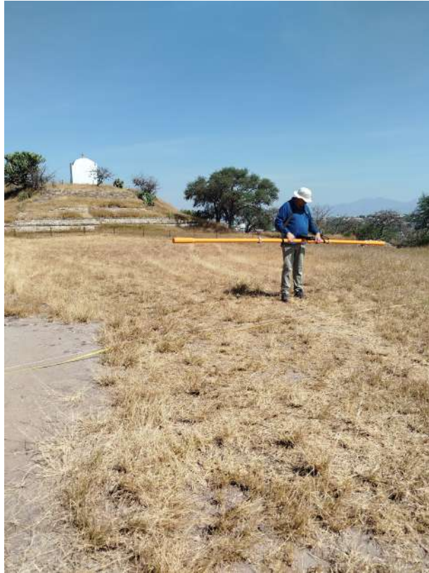
Figura 73: Adquisición de conductividad electromagnética en la zona arqueológica (2024).
