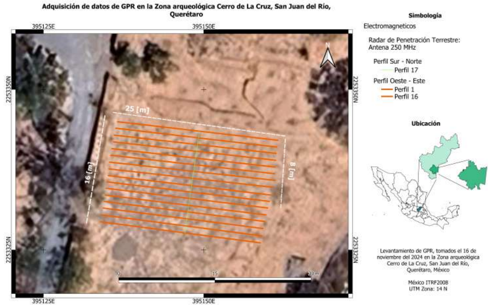
Figura 38: Adquisición de datos de Radar de Penetración Terrestre. Antena: 250 MHz. Elaborado en QGis (2025)
