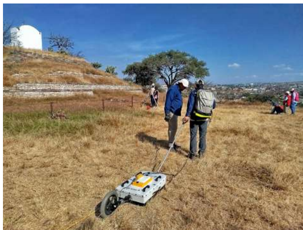
Figura 74: Adquisición de Radar de Penetración Terrestre en la zona arqueológica (2024).
