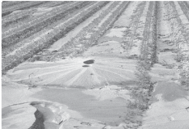
Figura IV.9 Volcán de arena en un campo de cultivo. Evidencia de licuación.
