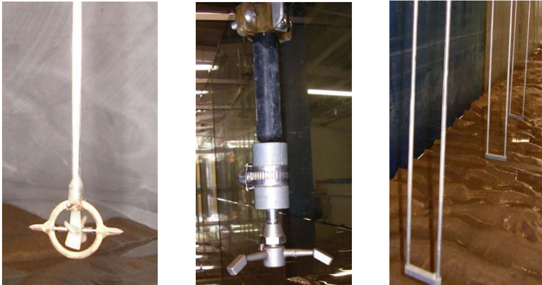
Figura 5-2 - Equipo de medición. Izquierda: micro propela, centro: ADV, Derecha: sensores de nivel
