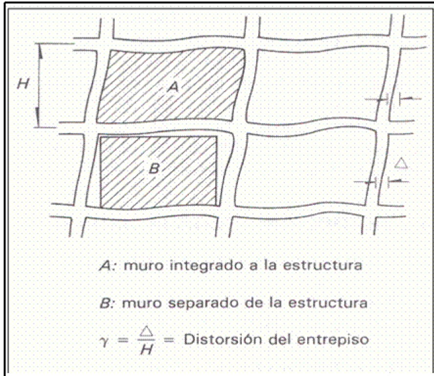
Fig. 7.6 Distorsiones de entrepiso admisibles según el RCDF
