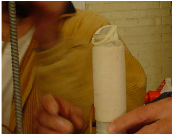
Colocación de la membrana (preservativo), y sujeción del espécimen al cabezal de la cámara.
