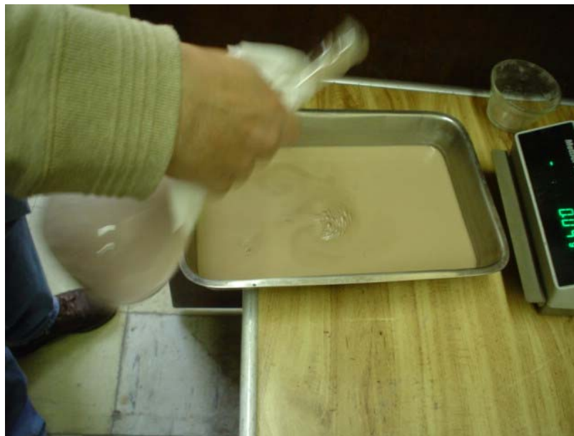
Fotografía 15 Vaciado del suelo
