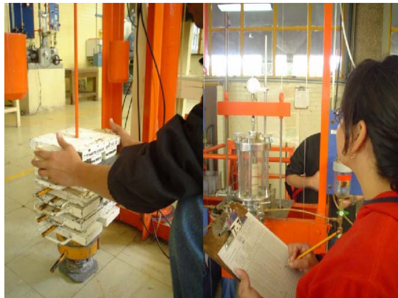
Fotografía 27 Incremento de carga al espécimen y toma de lecturas
