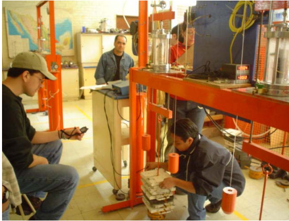
Incrementos de carga al espécimen para llevarlo a la falla.
