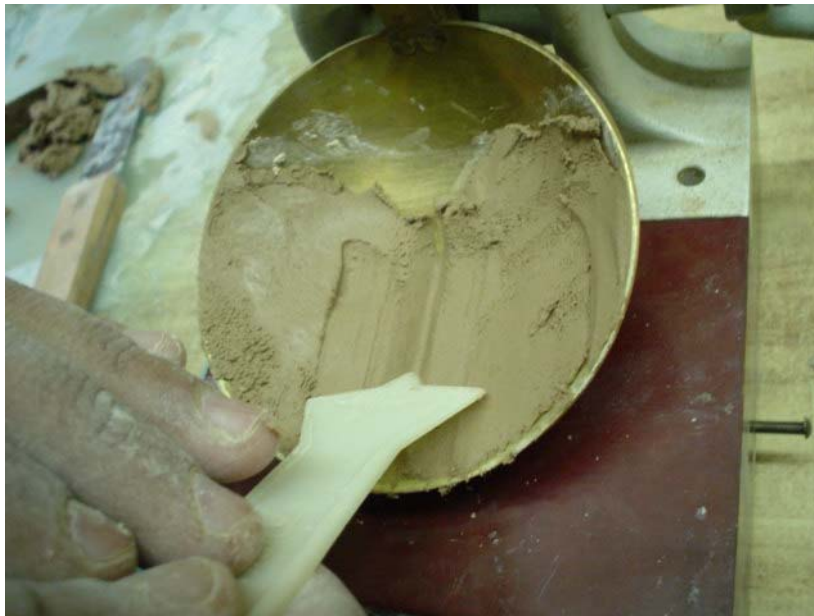
Fotografía 7 Ranuración del suelo.
