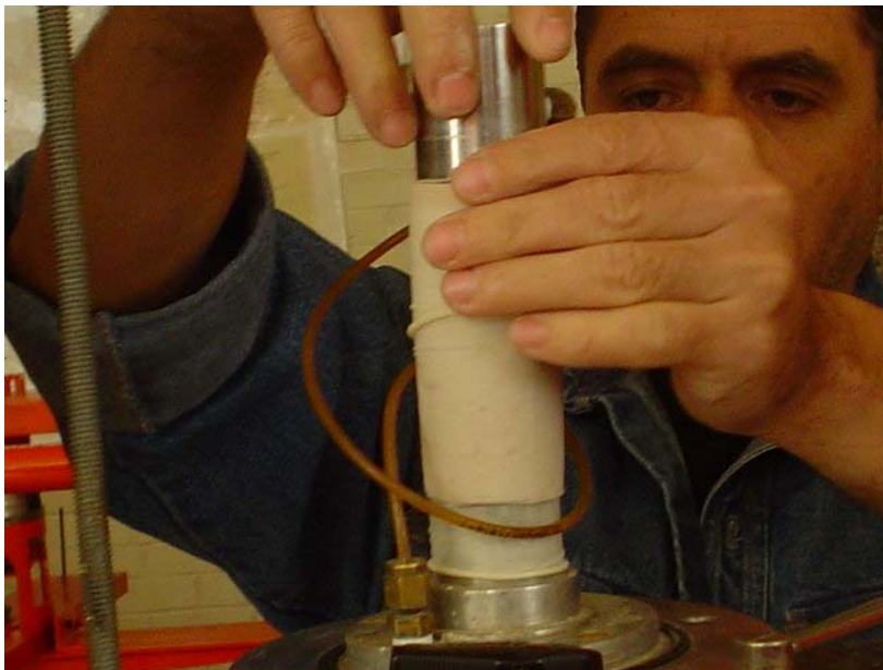
Fotografía 25 Colocación del cabezal sobre el espécimen
