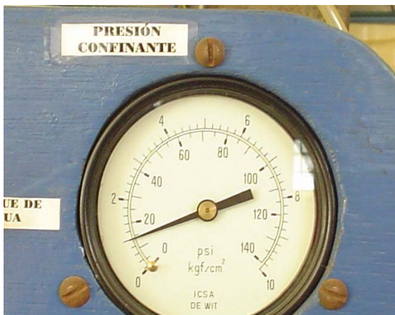
Manómetro para medir la presión hidrostática, (confinante).
