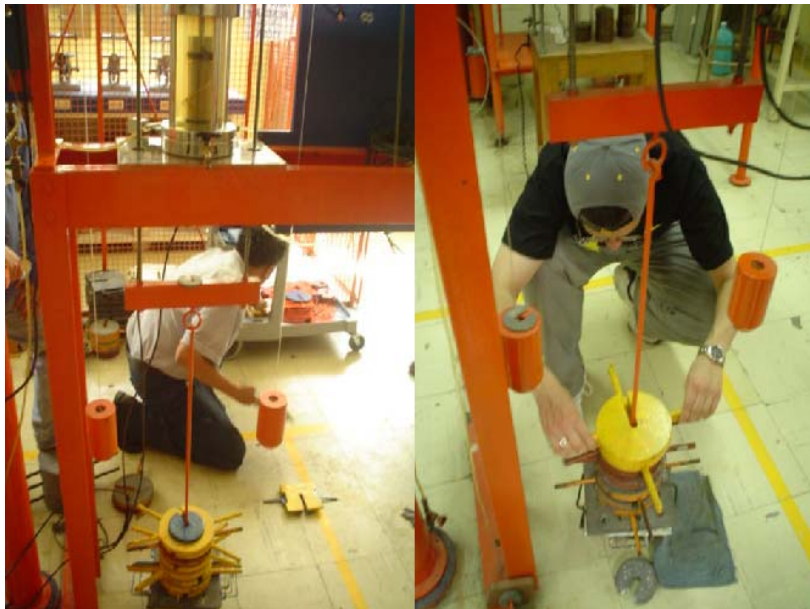
Fotografía 39 Colocación de las cargas.
