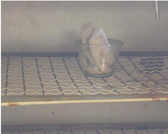
Colocación del espécimen en el horno de convección.
