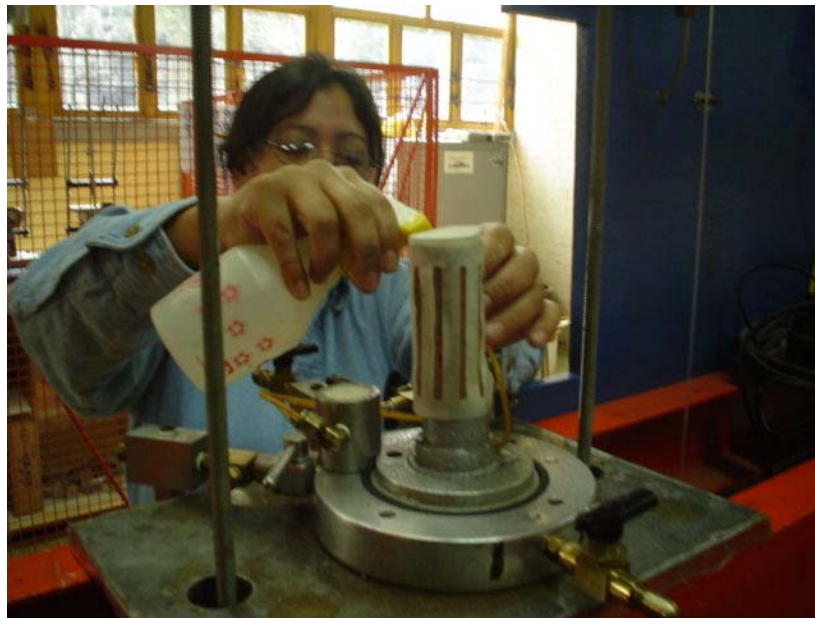
Fotografía 31 Colocación del papel filtro
