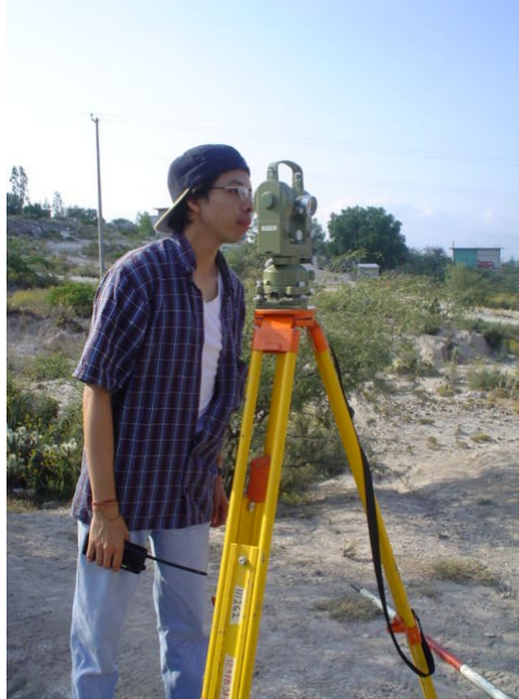
Fotografía 3 Teodolito Óptico de Mira Directa (T2 Wild)
