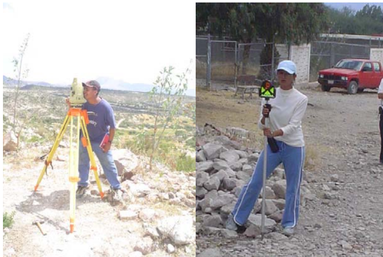
Fotografía 5 Mediciones con Estación Total (Leica TC-600)
