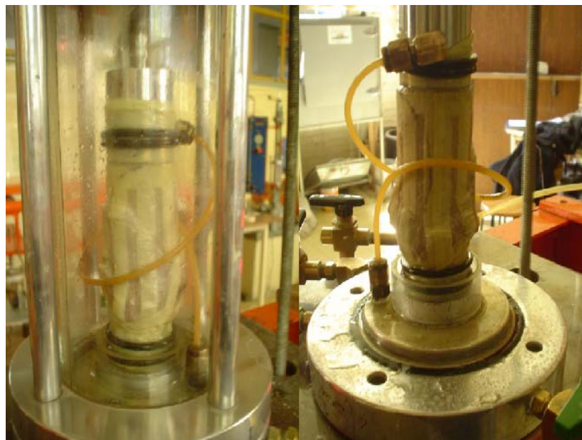
Fotografía 41 Drenado de la cámara.
