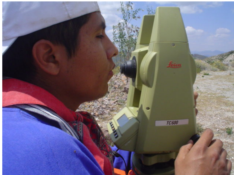
Fotografía 4 Estación Total (Leica TC-600)
