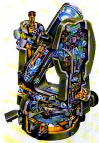
Figura 9 Dibujo de corte del teodolito de segundos Kern DKM2-A, mostrando los diferentes elementos que lo componen.
