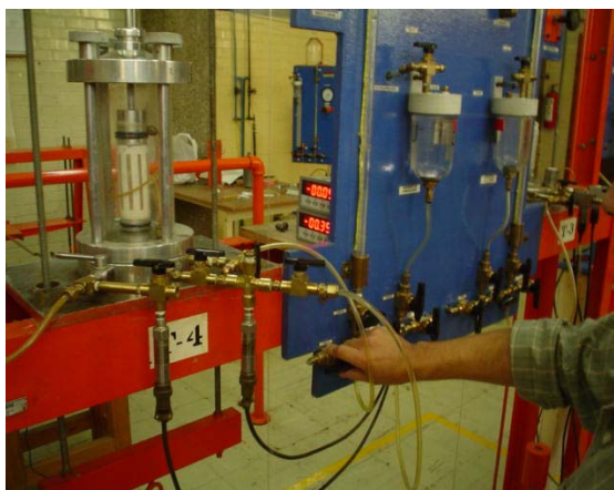
Saturación del espécimen de suelo, aplicando una presión hidrostática (confinante).
