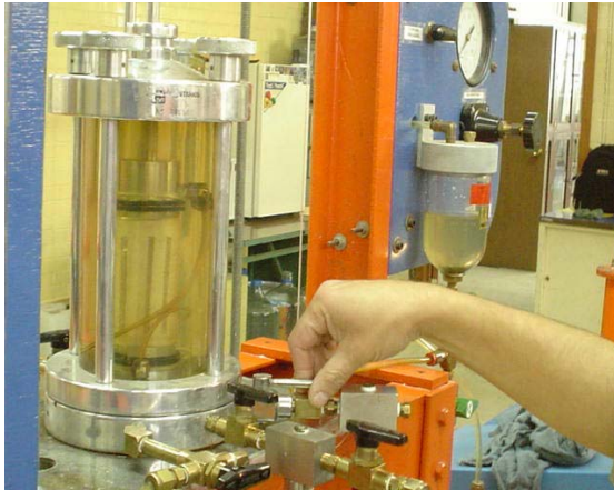
Espécimen saturado bajo la acción de una presión hidrostática.
