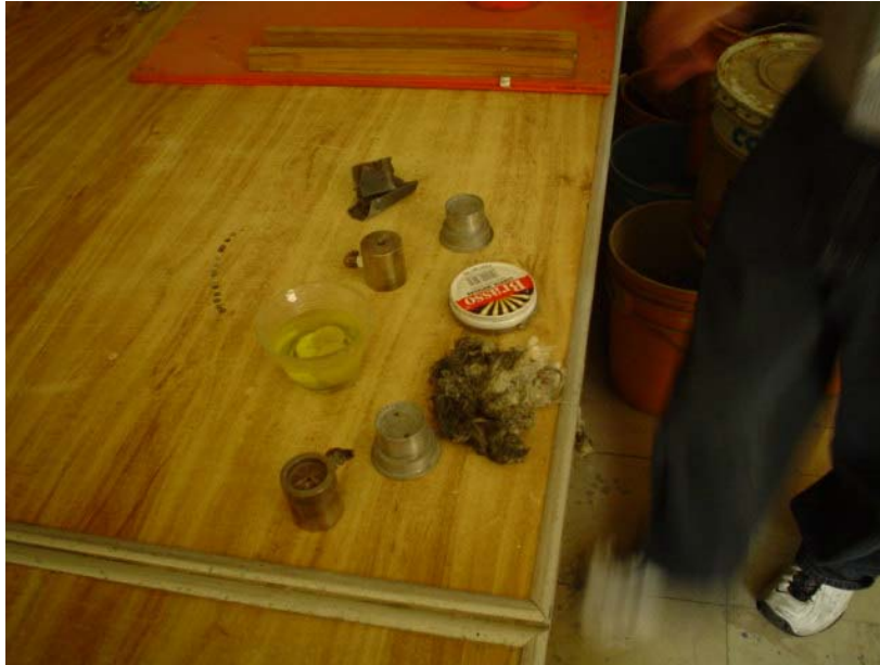
Fotografía 34 Limpieza de los filtros de los cabezales de la cámara
