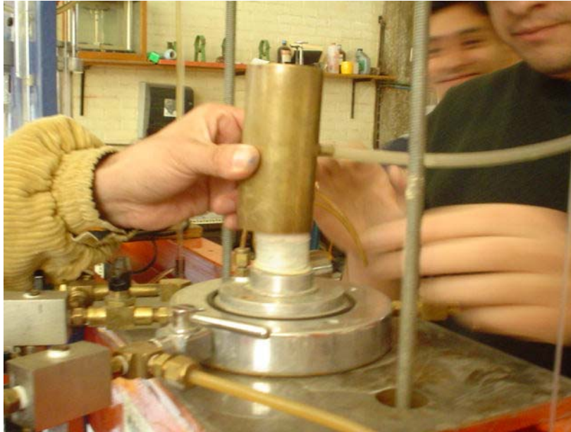
Fotografía 24 Succión de aire para adherir la membrana al espécimen
