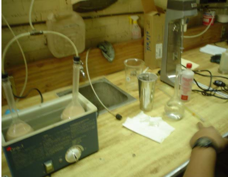
Fotografía 14 Eliminación de aire del suelo
