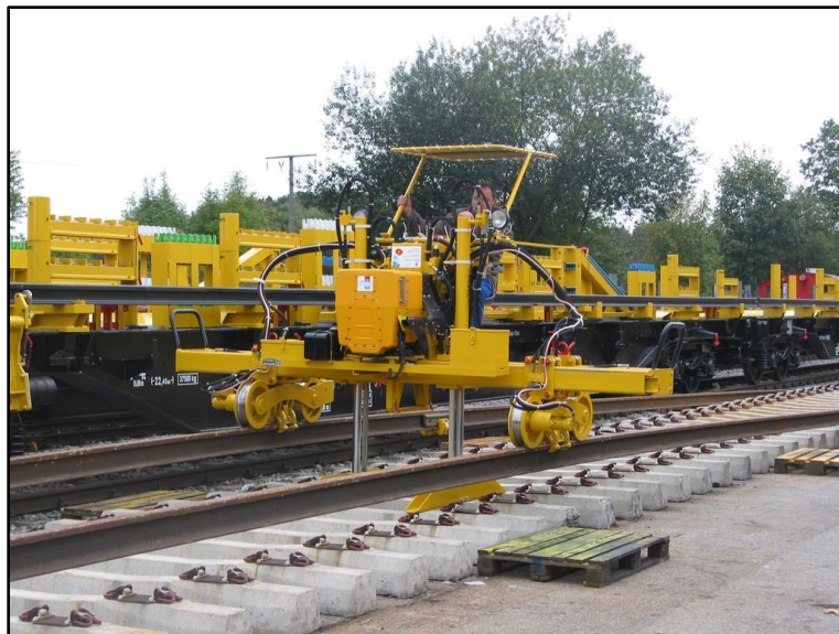
Figura 7. Posicionadora de rieles. (Robel, 2013)
