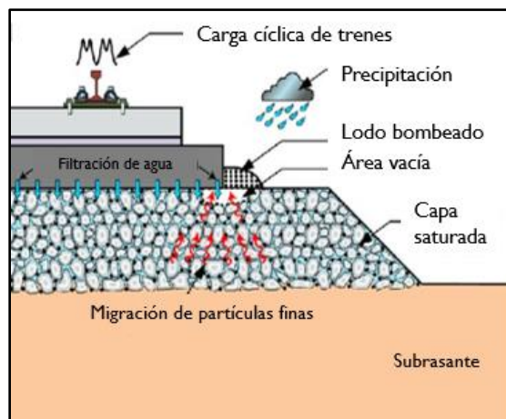
Figura 12. Efecto de bombeo de lodo de finos en los durmientes y balasto. (Wan et al., 2022)
