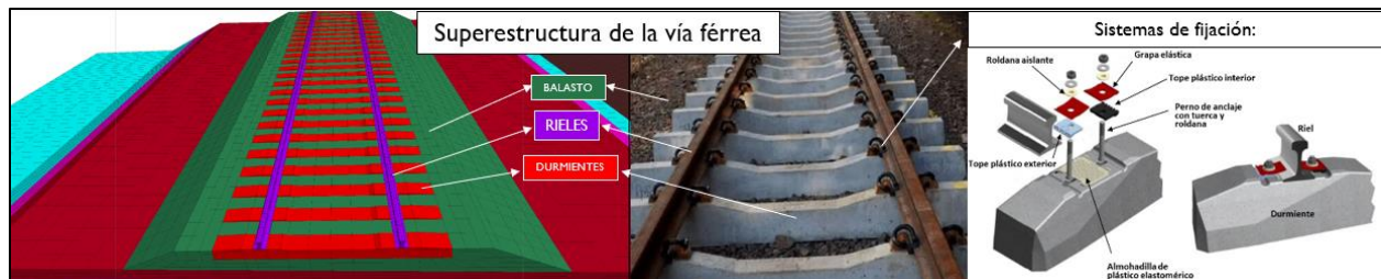
Figura 4. Superestructura de la vía férrea.
