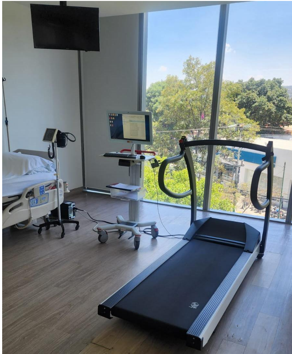
Figura 4.1.7a. Sistema de prueba de esfuerzo en un área de cardiología, compuesto por banda sinfín (caminadora), monitor y estación de cómputo con software especializado para la adquisición y análisis de datos en tiempo real.
