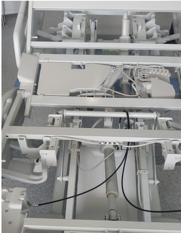
Figura 4.1.1a. Vista superior de la cama Hillrom mostrando motores eléctricos, control box y cableado.
