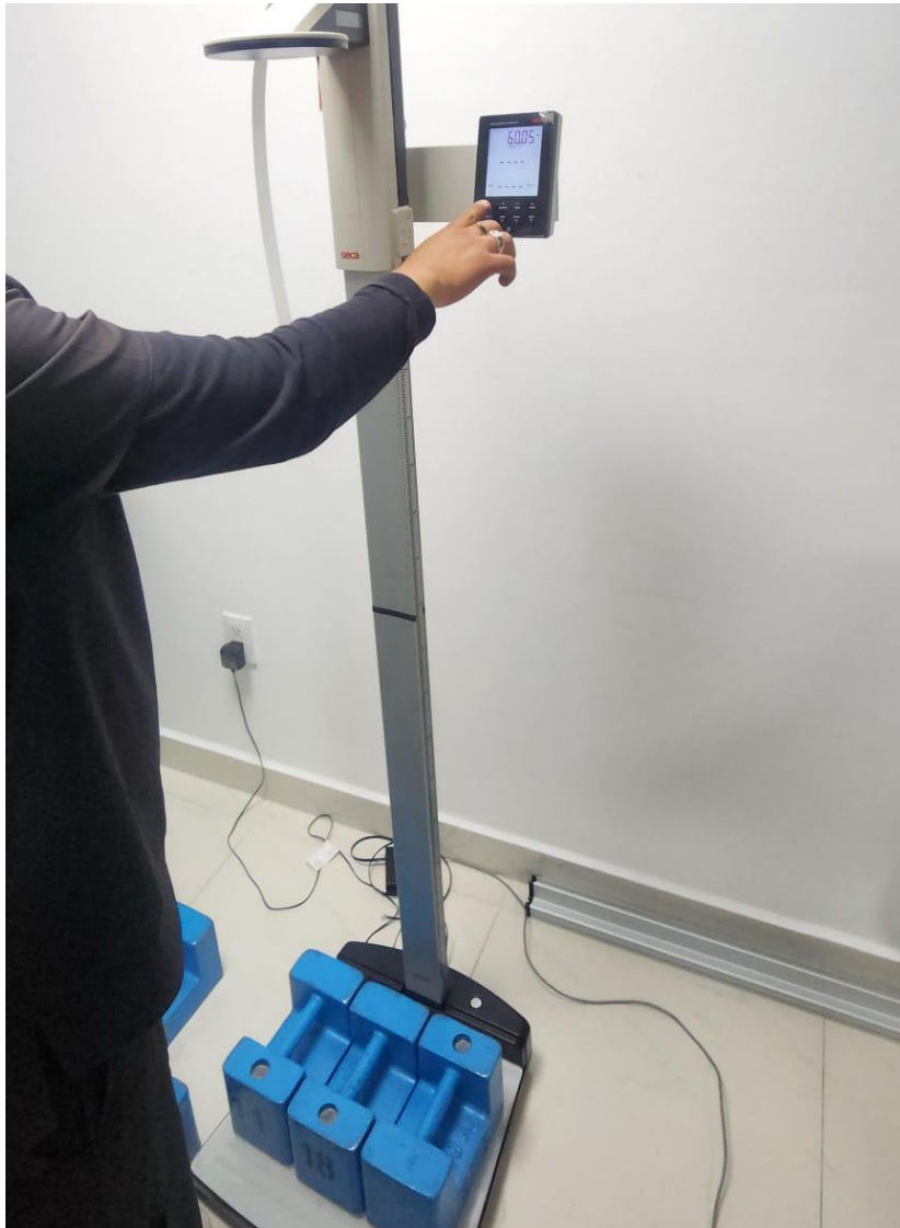
Figura 4.2.1c. Calibración de báscula electrónica con software externo, donde se corrige celda por celda utilizando masas patrón y un programa especializado que genera registro digital del proceso.
