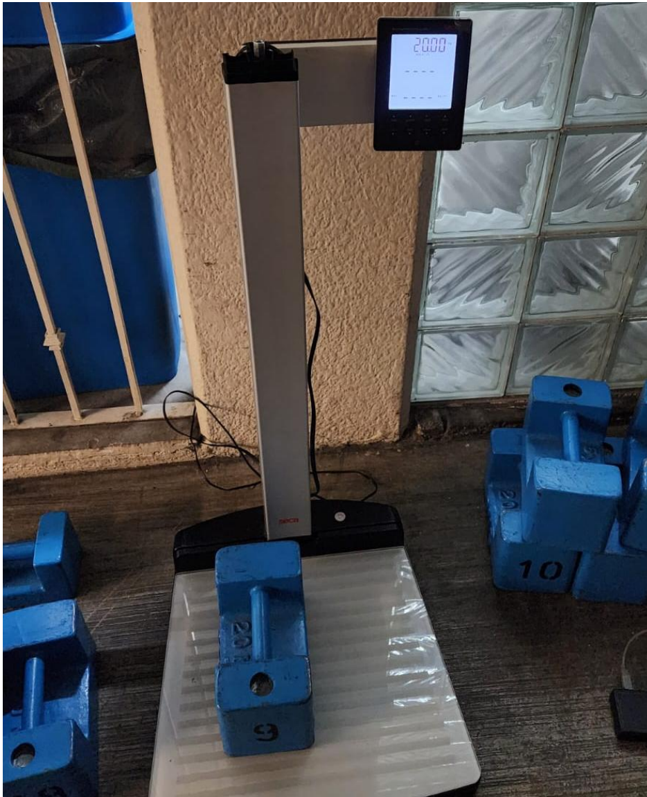
Figura 4.1.2b. Báscula SECA con estadímetro, calibrada mediante masa patrón de 20 kg; el resultado mostrado en pantalla coincide con el valor real.
