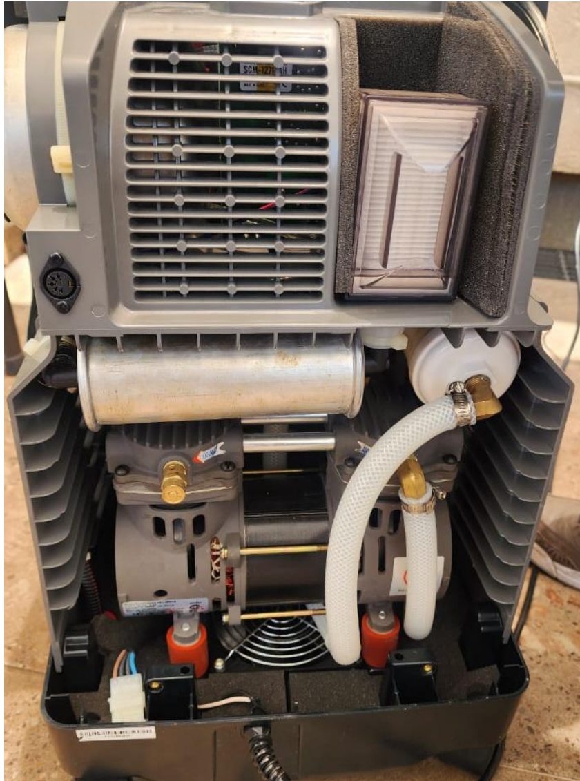
Figura 4.1.4a. Vista interna de un concentrador de oxígeno portátil, mostrando compresor, ventilador y filtros. La inspección de estos componentes permite diagnosticar obstrucciones y garantizar un flujo continuo de oxígeno.
