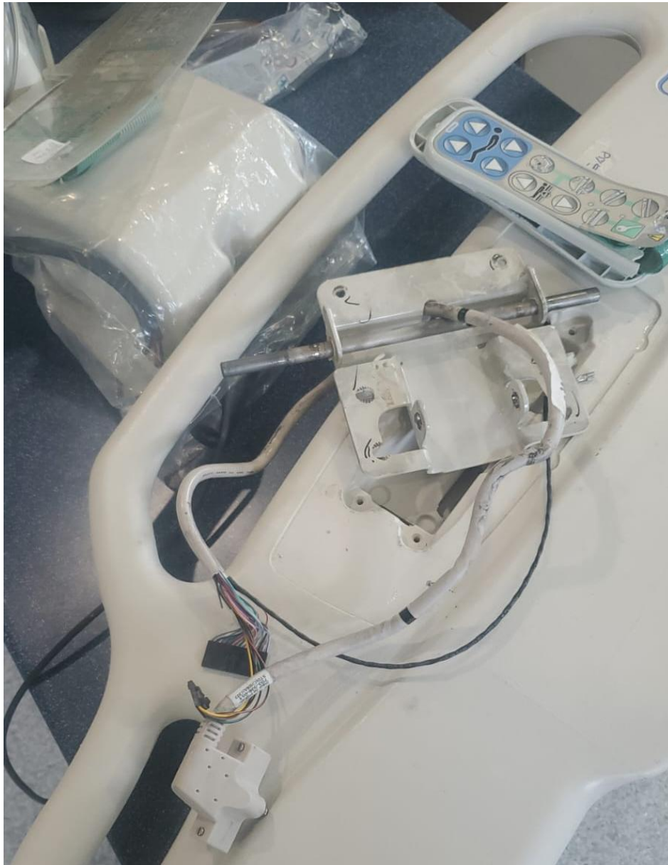
Figura A.1.2. Ejemplo de mantenimiento correctivo en barandal de cabecera de cama Hillrom. La falla fue causada por un cable con rupturas internas que impedía el control de movimientos. Para optimizar recursos, se sustituyó únicamente el cable en lugar de reemplazar todo el barandal.
