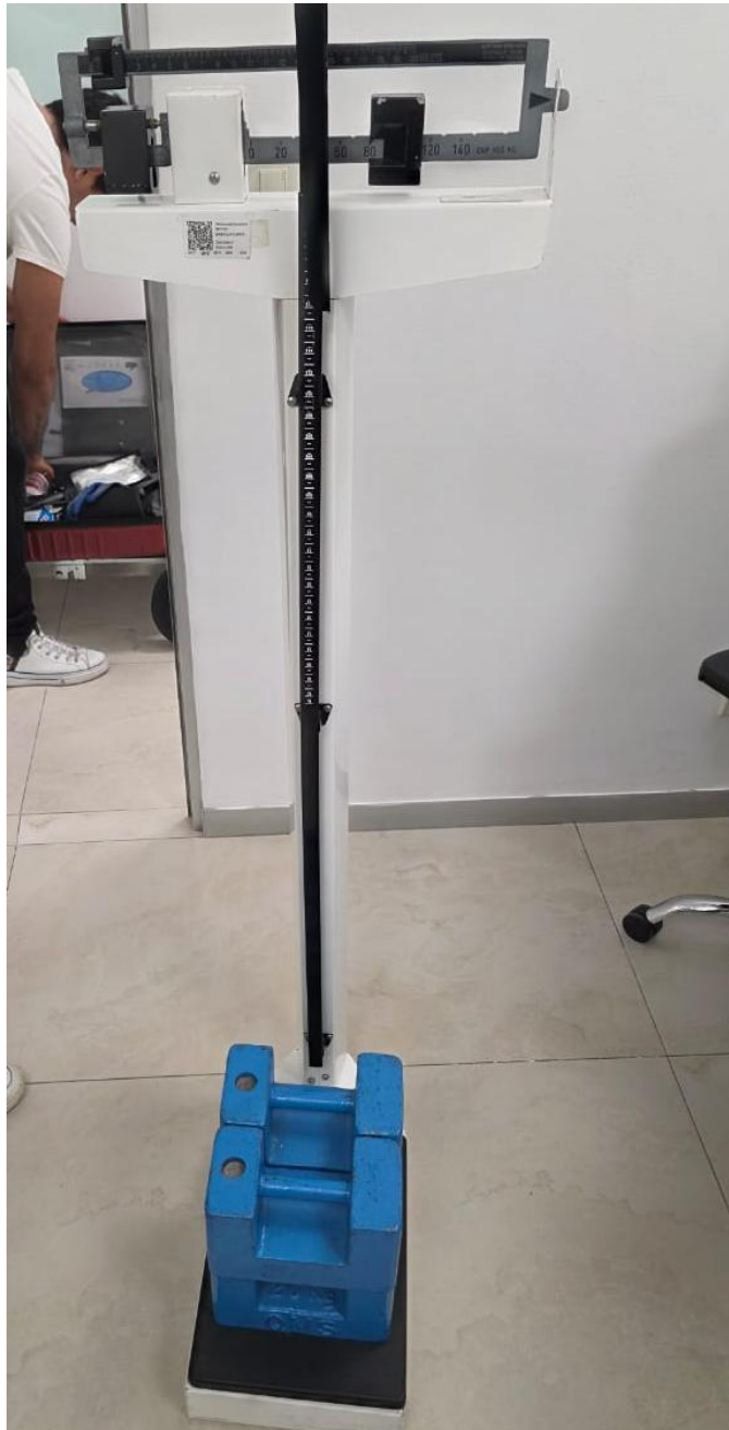
Figura 4.2.1a. Calibración de báscula mecánica mediante el uso de masas patrón certificadas, ajustando el sistema de contrapesos para garantizar la exactitud de las mediciones.
