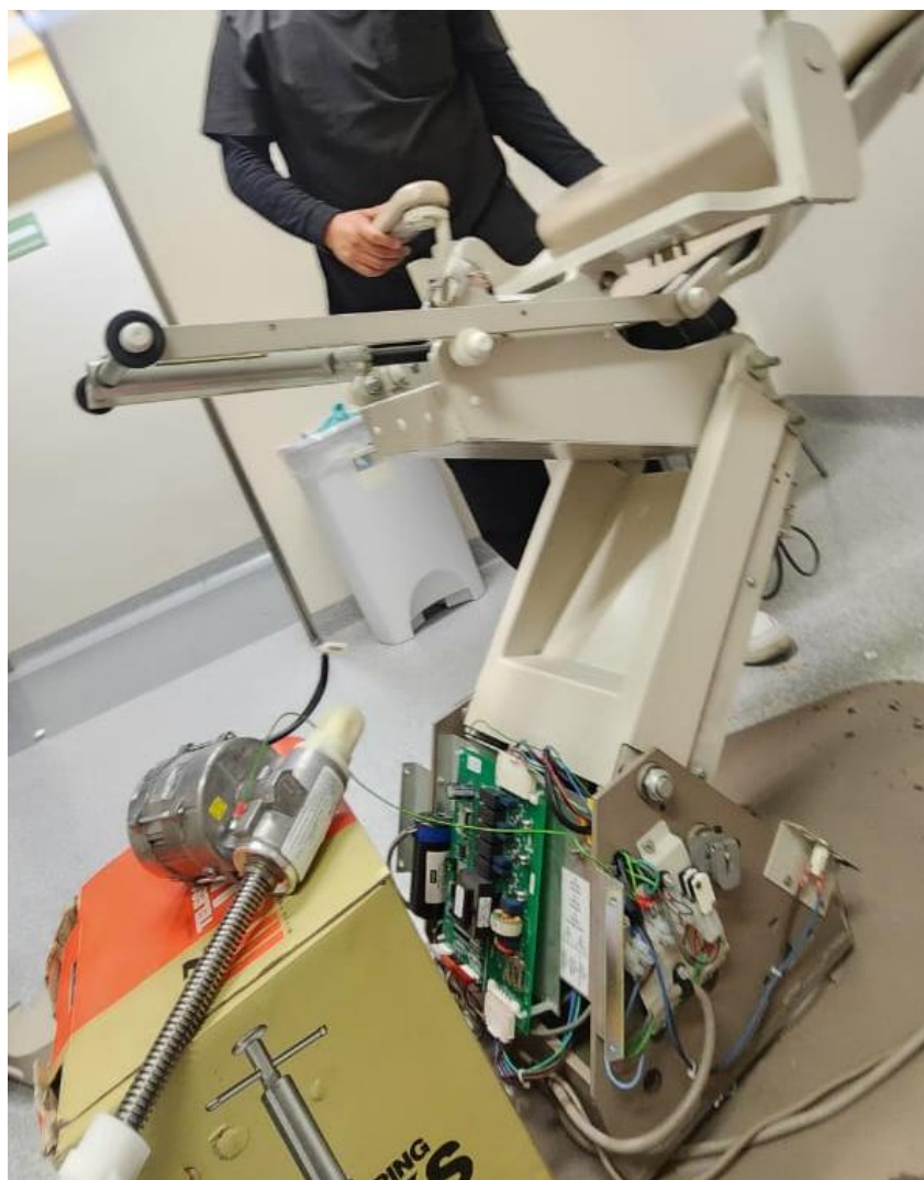
Figura A.5.1. Vista general de la mesa de exploración Knight Biltmore abierta, evidenciando la disposición de sus componentes internos.
