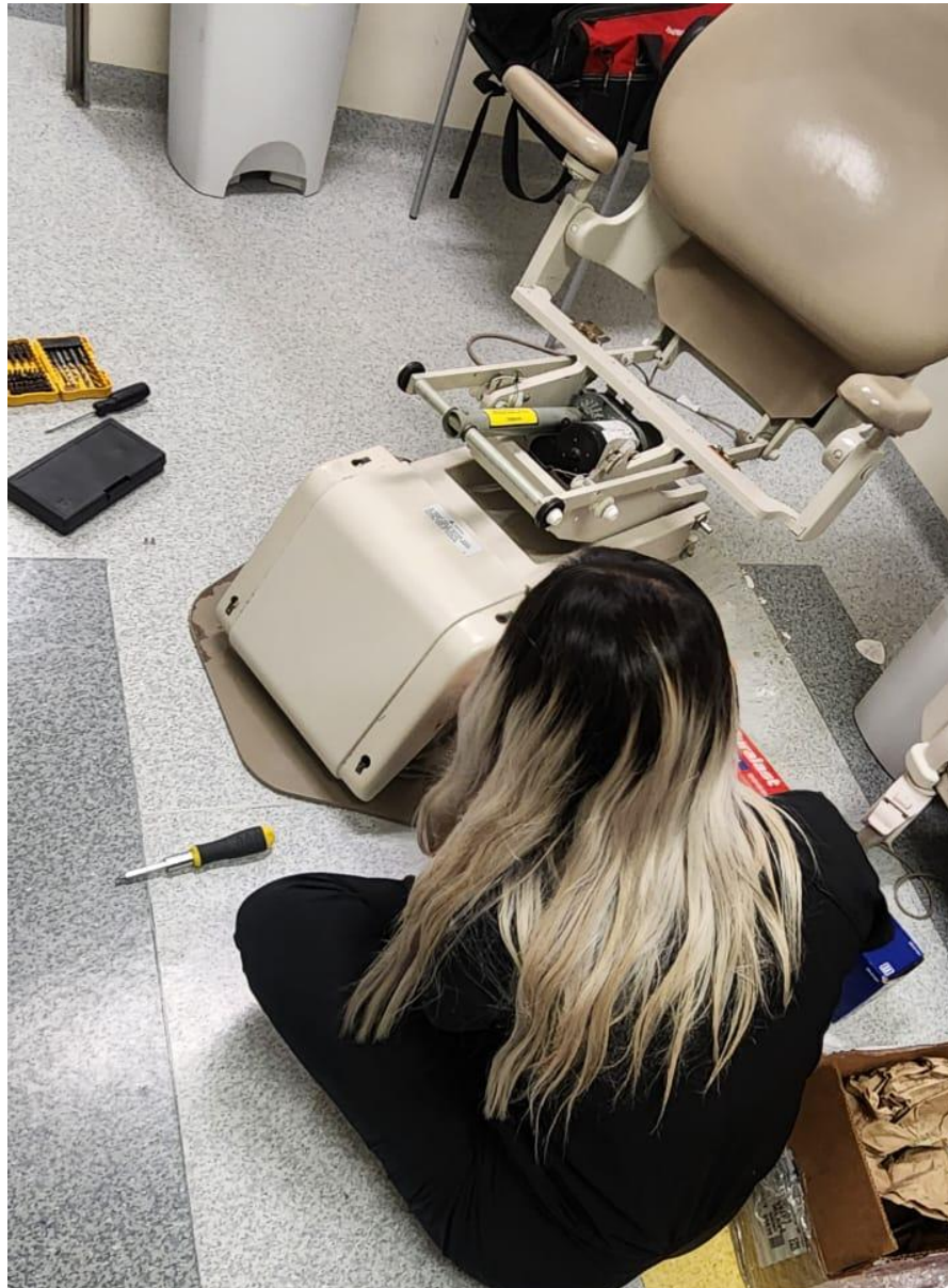
Figura A.5.2. Diagnóstico biomédico en una mesa de exploración Knight Biltmore, procedimiento inicial para identificar fallas en sus sistemas eléctricos y mecánicos.
