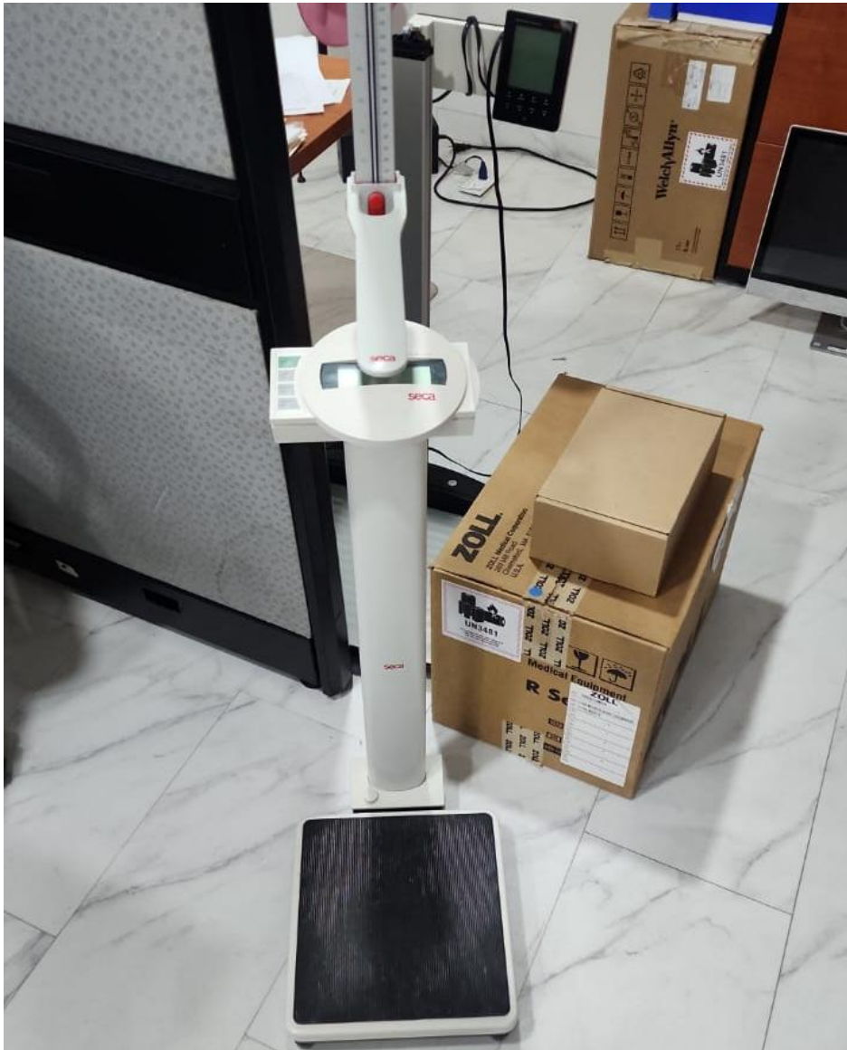
Figura A.2.3. Báscula SECA 769, una de las básculas más comunes, que incluye estadímetro.
