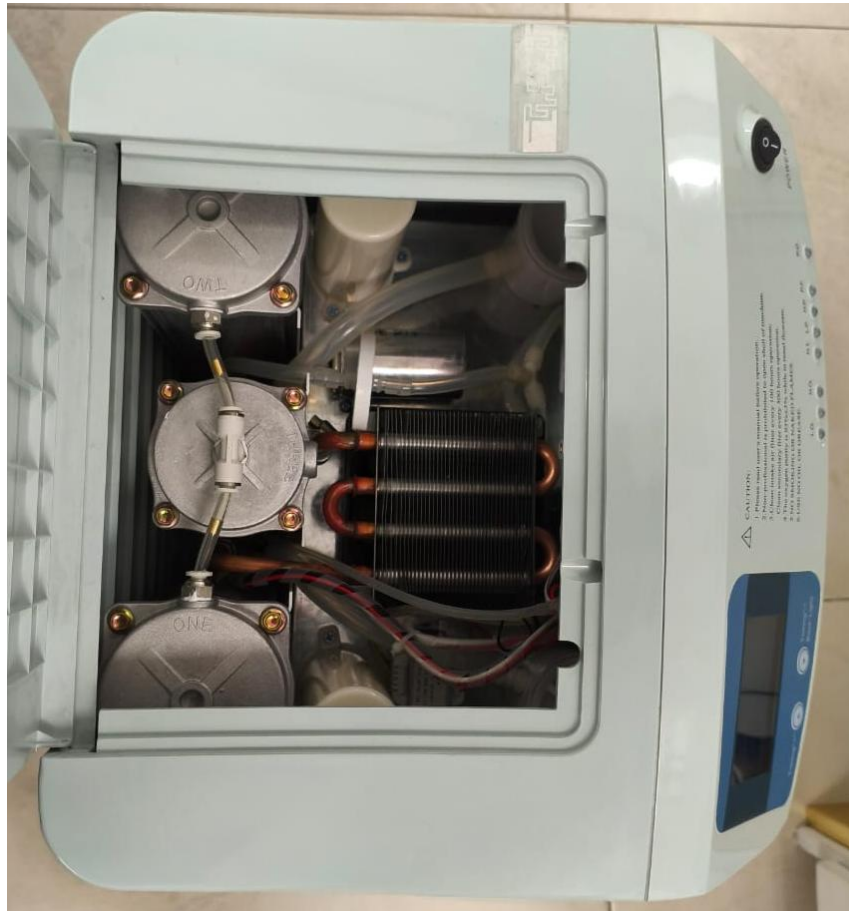
Figura 4.1.4b. Interior de un concentrador de oxígeno, donde se aprecian el compresor y el sistema de tuberías. El mantenimiento en esta sección incluye la revisión de mangueras, conexiones y la sustitución de filtros y componentes desgastados.
