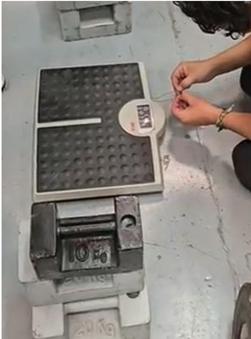
Figura 4.2.1b. Calibración de báscula electrónica con sistema de calibración lineal interna, donde la corrección se aplica de manera conjunta a todas las celdas de carga a través del módulo interno del equipo, se tiene que hacer un puente para poder acceder al modo calibración.
