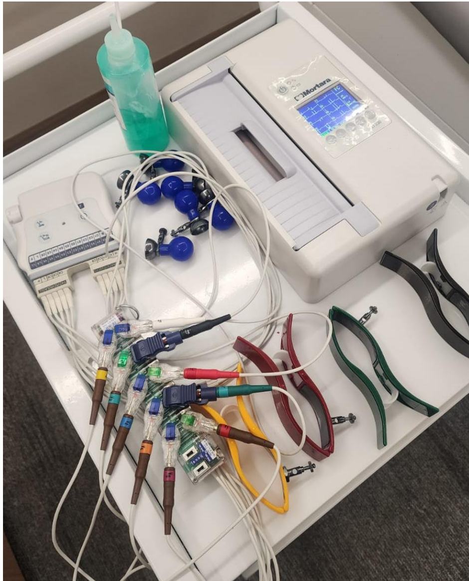
Figura 4.1.3b. Conexión de un electrocardiógrafo (lado derecho esquina superior) a un simulador calibrado (lado izquierdo esquina inferior). Este procedimiento permite verificar si las fallas detectadas provienen de los cables de los electrodos, del módulo de adquisición de señal o del monitor. De esta manera se asegura un diagnóstico preciso de la avería.
