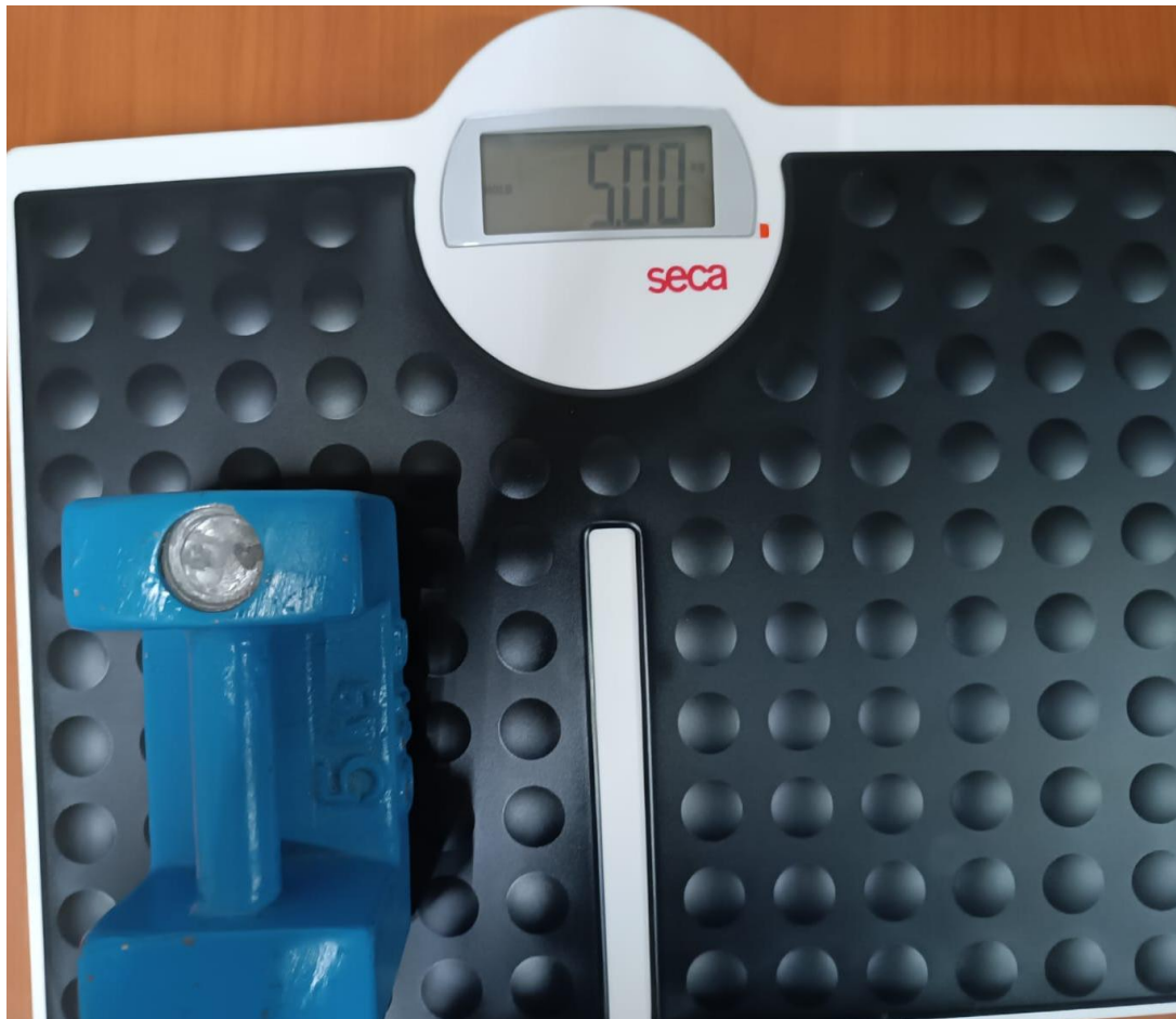
Figura A.2.2. Báscula SECA para adultos sencilla, sin estadímetro; en este tipo de equipos no resulta costeable reemplazar celdas debido a su bajo valor comercial.
