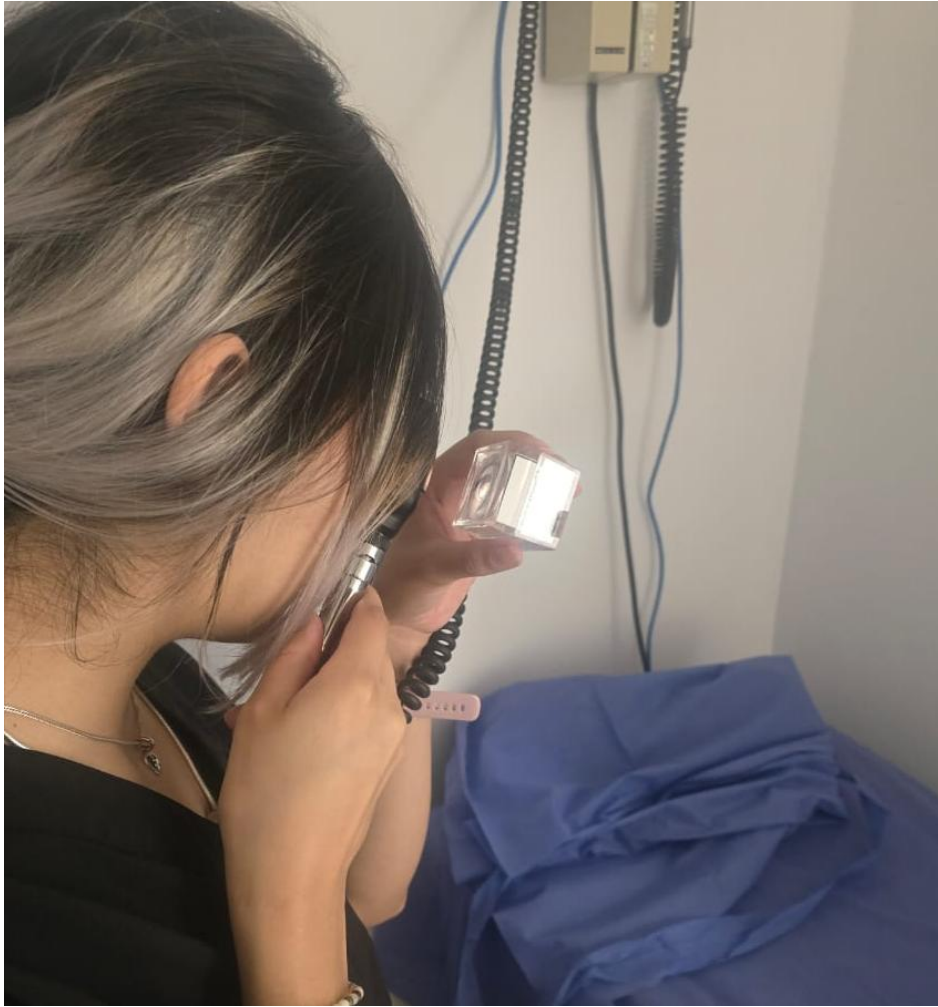
Figura 4.1.5b. Prueba de funcionamiento del oftalmoscopio con un simulador de retina, utilizada para verificar la calidad de la iluminación y las ópticas.
