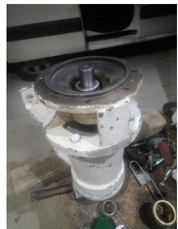
Reemplazo del sello mecánico en los impulsores de las bombas.
