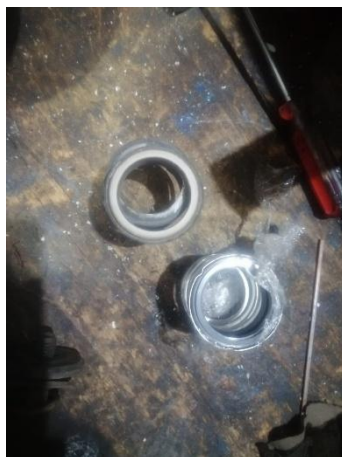
Reemplazo del sello mecánico en los impulsores de las bombas.
