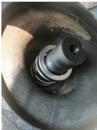
Reemplazo del sello mecánico en los impulsores de las bombas.
