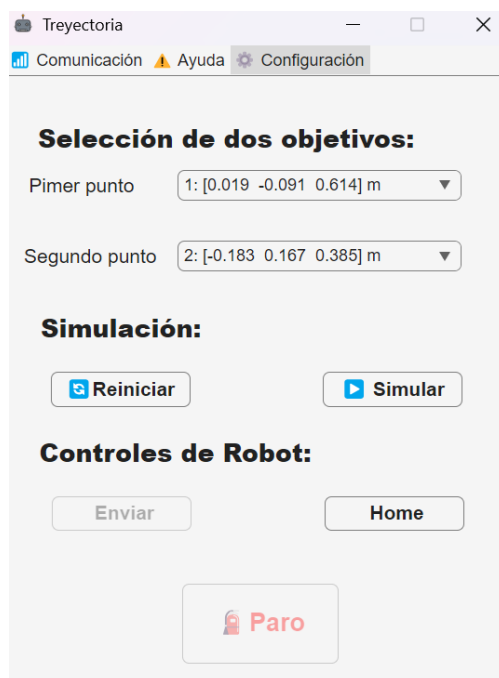
Figura 6.7: Captura de pantalla de la interfaz para aplicación de seguimiento de trayectorias
