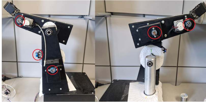
Figura 3.2: Ubicación de los sensores de posición en el robot MENTOR.
