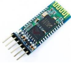
Figura 48. Módulo Bluetooth HC – 05 [61].
