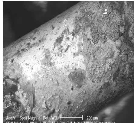
Figura 4.14. Terminal de una resistencia con desprendimiento de película de estaño y formación de depósitos complejos. [Cueva, I., 2006]
