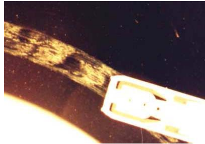
Figura 5.17. Roce entre el cabezal de lectura/escritura y la superficie del plato del disco.
