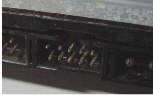
Figura 5.28. Pines de interconexión con acumulación de condensado originando así la formación de sulfatos.
