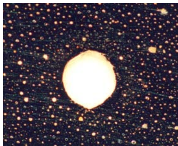
Figura 5.11. Superficie de SAMD con depósitos de condensado y residuos salinos. [Sánchez, F., 2005]
