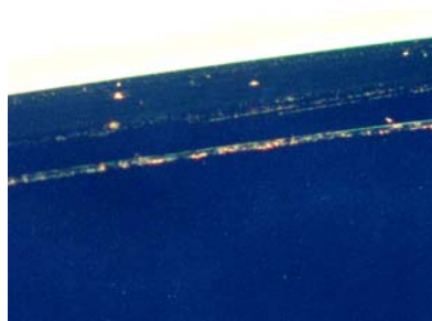
Figura 5.56. Deterioro sobre de la periferia del disco.
