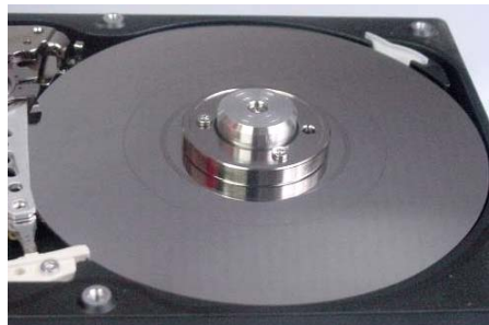
Figura 5.10. Superficie rayada a causa del contacto del cabezal lectura/escritura con el plato.
