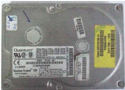
Figura 5.26. Apariencia de la carcava de un disco duro. Nótese que dependiendo del material de la carcava se tiene deterioro en mayor o menor medida sin dejar de existir el mismo en estos elementos.
