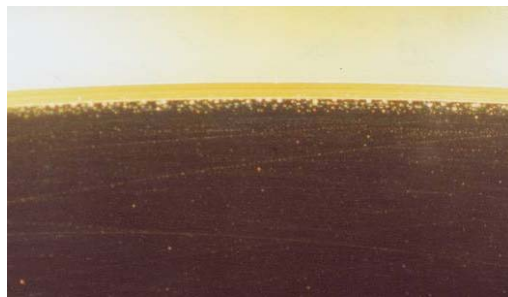
Figura 5.30. Acumulación de condensado sobre la periferia del plato.
