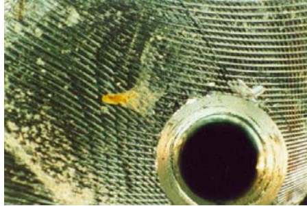
Figura 5.34. Acumulación de condensado y formación de óxidos en el límite de los barrenos de sujeción.
