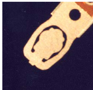
Figura 5.55. Cabeza de L/E sobre superficie del plato sin presentar deterioro alguno.
