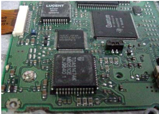
Figura 5.29. Tarjeta controladora de un disco duro con acumulación de condensado afectando todos los elementos que la componen.
