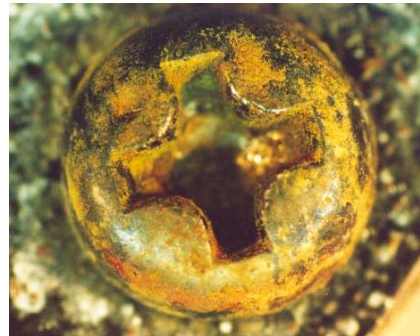
Figura 5.38. Tornillo de la carcasa del disco con formación de óxidos.
