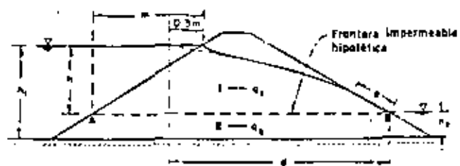
Fig 5.12 Determinación del punto de salida de la línea superior de flujo en una sección homogénea con tirante aguas abajo
