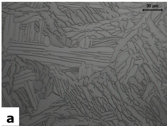
Figura 33. Microestructura de Ti-6Al-4V enfriada en aire (AQ): a) obtenida por Sugahara et al. [27] b) elaboración propia a un aumento objetivo de x10.
