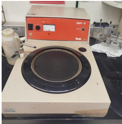
Figura 20. Equipos de desbaste y pulido. Laboratorio CENISA.
