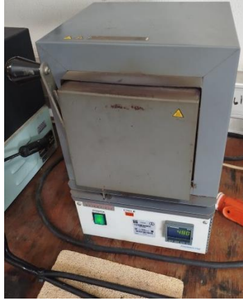
Figura 21. Mufla [Thermo scientific]. Laboratorio CENISA.
