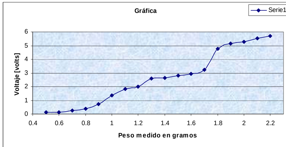
Figura 3.15. Gráfica de desplazamientos realizados con \text{TiO}_2 , podemos observar la variación de el voltaje (deflexión de haz láser captada por el sensor) con respecto a la sustancia agregada, observamos que el sistema presenta un comportamiento casi-lineal, es decir, con cada incremento de 0.1 [gramos], la respuesta del sistema fue creciendo de manera proporcional, gracias al nivel de sensibilidad que nos proporciona la técnica hasta alcanzar su punto máximo de voltaje.
