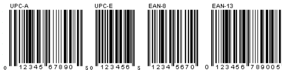
Figura I.3. Códigos de barras UPC-A, UPC-E, EAN-8 y EAN-13.
