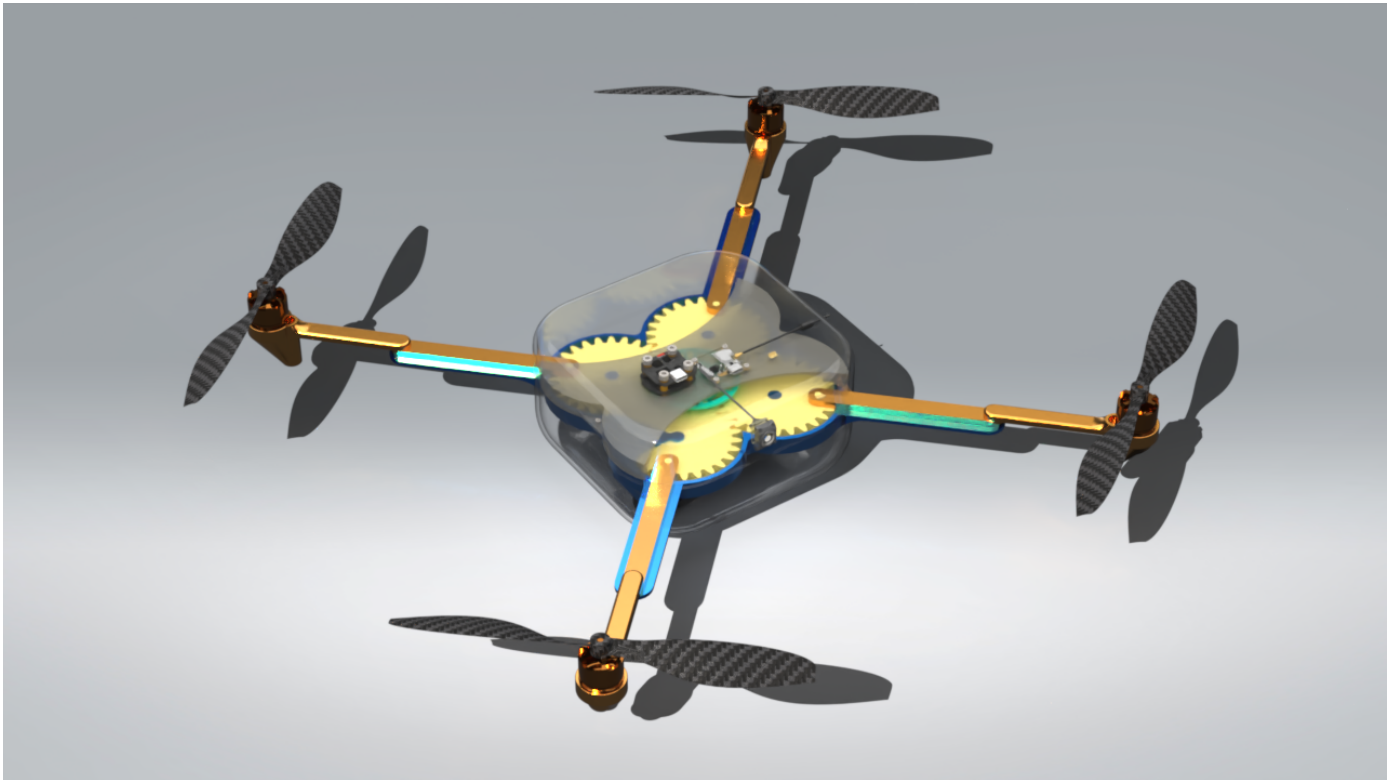
Figura III.21: Perspectiva aérea oblicua del sistema desplegado. Póngase especial atención en la simetría radial del ensamble y en la holgura geométrica existente entre el barrido de las hélices de fibra de carbono y el chasis central.
