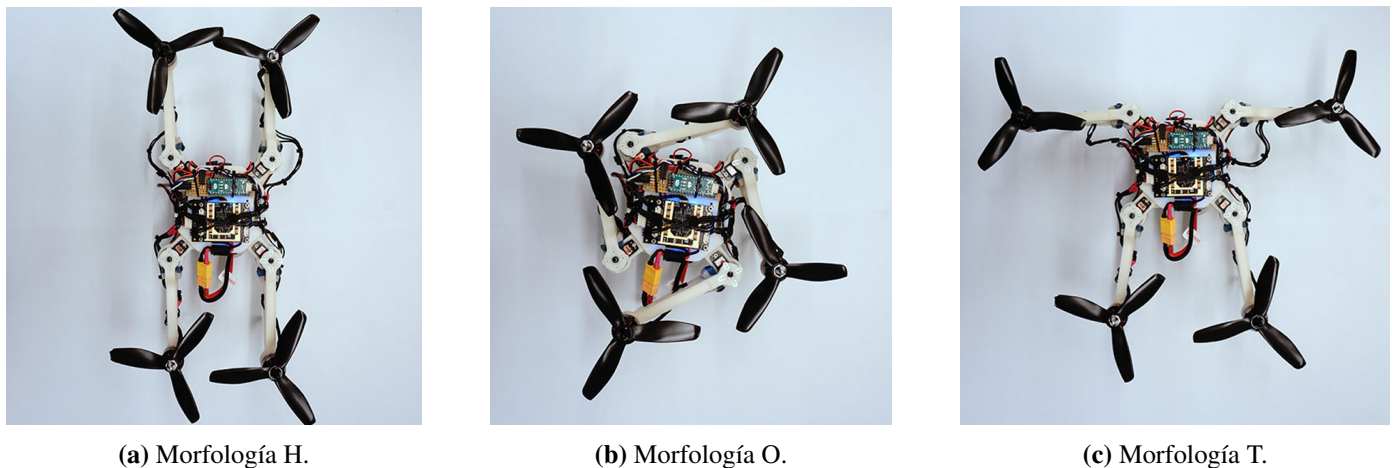
Figura I.3: Diferentes morfologías del dron reconfigurable. Se muestran las configuraciones (a) H, (b) O y (c) T. [17]
