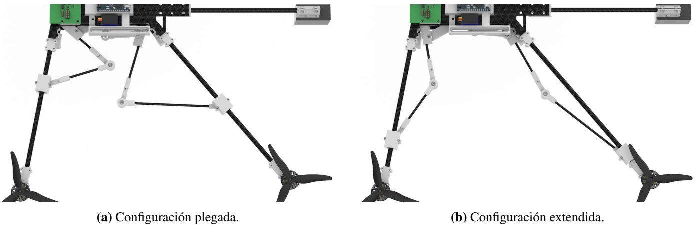
Figura I.5: Análisis cinemático del mecanismo de despliegue. Comparación entre (a) la posición inicial de los eslabones y (b) la posición final para máxima envergadura.
