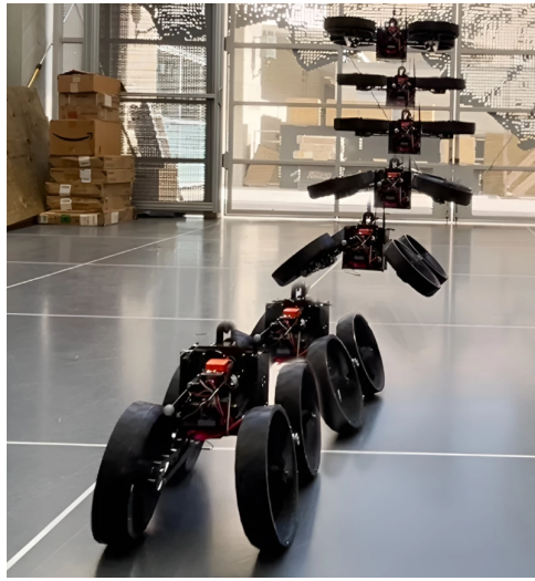
Figura I.7: Fotografía de la transición de vuelo de ATMO a aterrizaje sobre ruedas [25].
