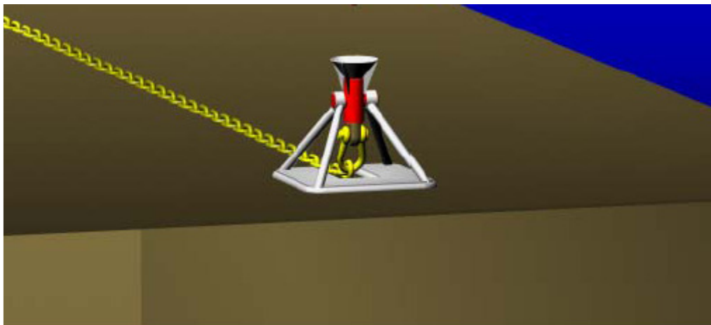
Figura II.13 Parte superior del pilote de cimentación.
