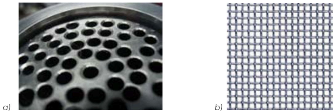
Figura 4.11. a) La imagen muestra la muesca o hendidura que sirve de porta-mallas en la placa rompedora; b) aquí se muestra un ejemplo del tipo de mallas que son utilizadas.
