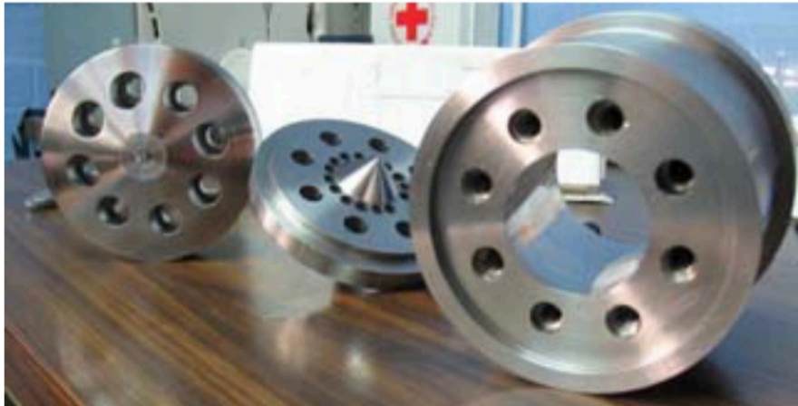
Figura 5.9. Tres componentes del dado terminados. En el soporte se puede observar la diferencia en el acabado superficial entre el canal de flujo y la cara que estará en contacto con el mandril.
