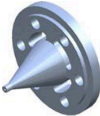
Figura 4.2. Mandril propuesto para el dado que utiliza un soporte conocido como "de brazos de araña" con cuatro brazos.
