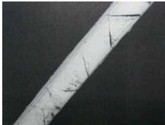
Figura 2.7. Imagen por microscopía electrónica que muestra las fisuras en un monofilamento de polietileno provocadas por una carga excesiva.
