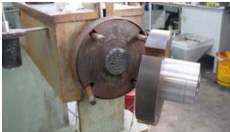
Figura 5.11. Montaje del dado en la brida del extrusor.
