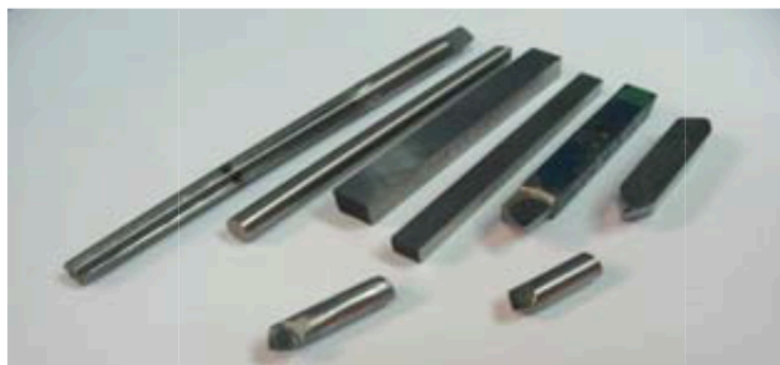
Figura 5.6. A la izquierda se muestra una rima usada para crear conicidades en el mandril; junto a la rima y en la parte inferior de la imagen se muestran buriles redondos utilizados
