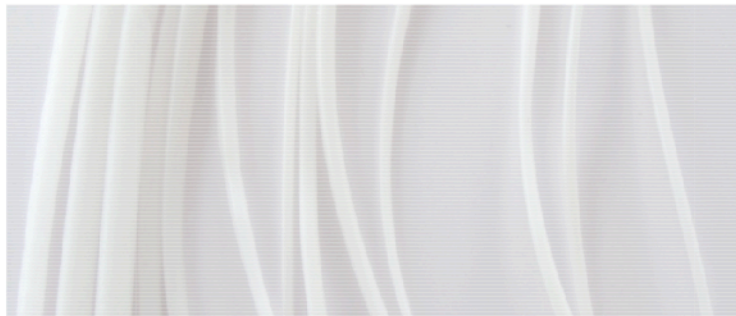
Figura 5.14. Estos son los perfiles que se pudieron obtener de polietileno de alta densidad para inyección.
