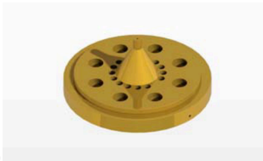
Figura 5.4. a) Aquí se observa el mandril desde una vista lateral; b) vista en perspectiva del mandril, se puede observar el canal de respiración que va desde la periferia exterior hasta la punta en el centro del cilindro superior.
