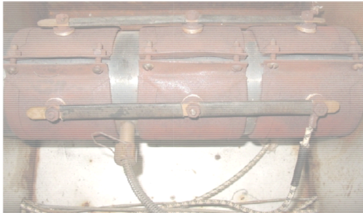
Figura 3.9. Resistencias de una de las tres secciones del cañón conectadas en paralelo.
