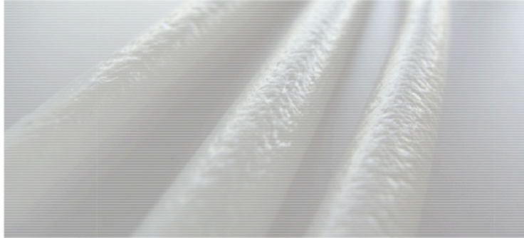
Figura 5.13. Primeros perfiles extrudidos de polietileno de alta densidad grado inyección.
