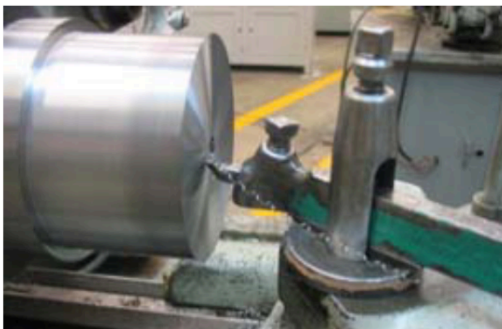
Figura 5.8. Proceso de desbaste en torno utilizando buriles con inserto de carburo de tungsteno. La pieza que se muestra es el soporte en su primera etapa de desbaste.
