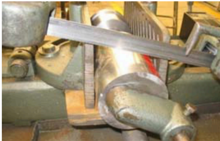
Figura 5.7. Cortes previos al inicio de los maquinados. Cada corte tardó aproximadamente 1 hora.
