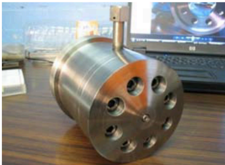
Figura 5.10. Finalmente el dado ensamblado mediante los ocho pernos y con el sujetador de termopar ya instalado.
