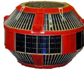
Ensamblaje de un satélite de masa pequeña 1.5
